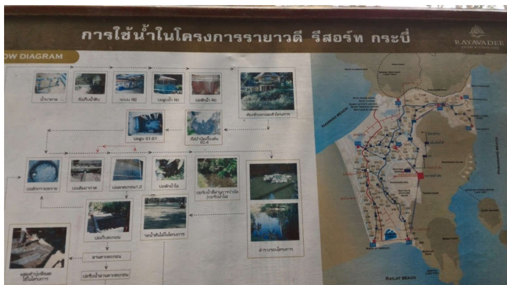
ภาพที่ 4.9 แผนผังการใช้และการบำบัดน้ำของโรงแรมรายาวดี
