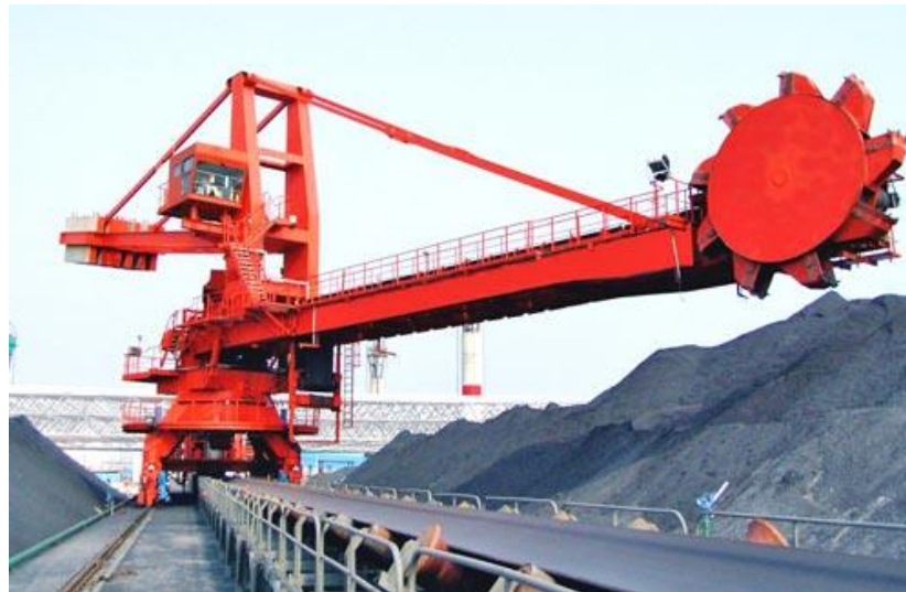
รูปที่ 6.2 Bucket wheel stacker & Bucket wheel reclaimer 4
