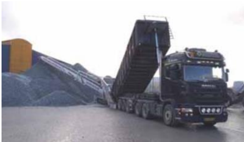
รูปที่ 6.6 การขนถ่ายเชื้อเพลิงถ่านหินจากรถบรรทุกลงสู่ลานกอง
