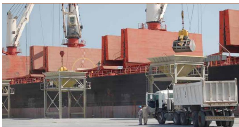
รูปที่ 6.5 การลำเลียงเชื้อเพลิงถ่านหินจากบริเวณท่าเรือใส่รถบรรทุกด้วย Hopper
