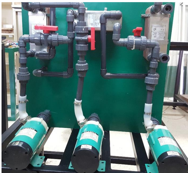
รูปที่ 44 Pumps สำหรับ strong desiccant, weak desiccant และ water sump
