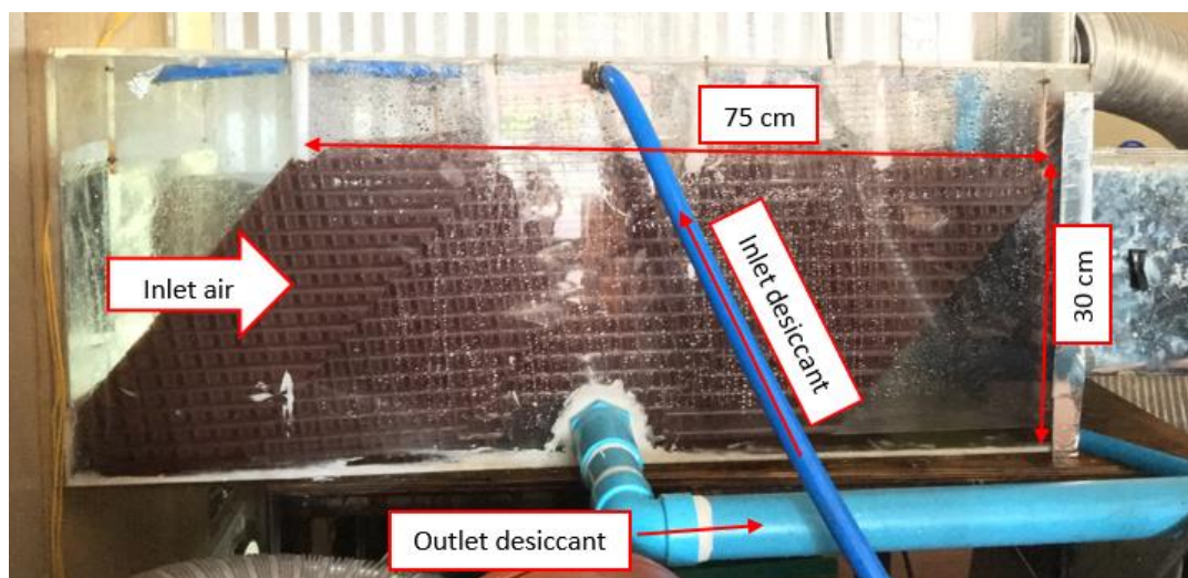
รูปที่ 108 Dehumidifier หลังการปรับปรุงการเรียงตัวของ cooling pad
