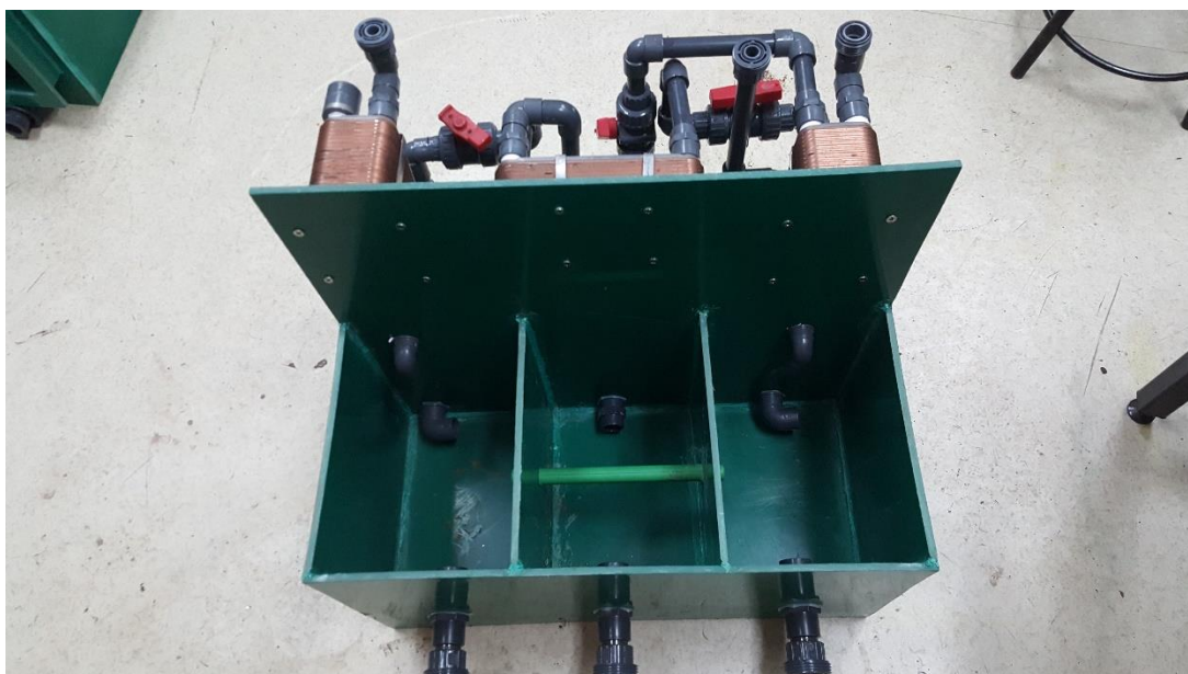
รูปที่ 42 strong desiccant sump, weak desiccant sump และ water sump
