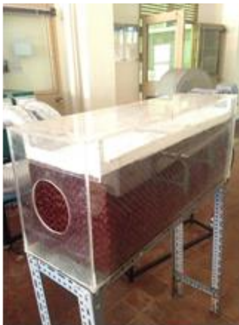
รูปที่ 85 Direct dehumidifier
