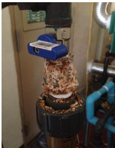
รูปที่ 60 โลหะที่ถูกสารดูดความชื้นกัดกร่อน
