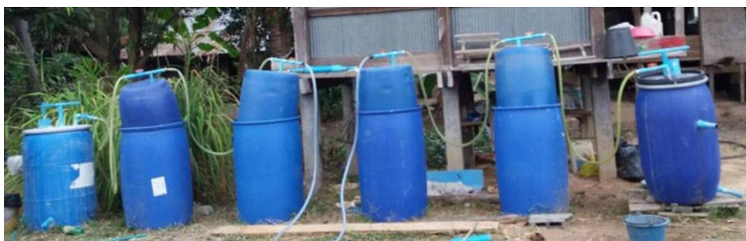
ชุดถังหมักและถังเก็บแก๊สที่ประกอบเสร็จ
