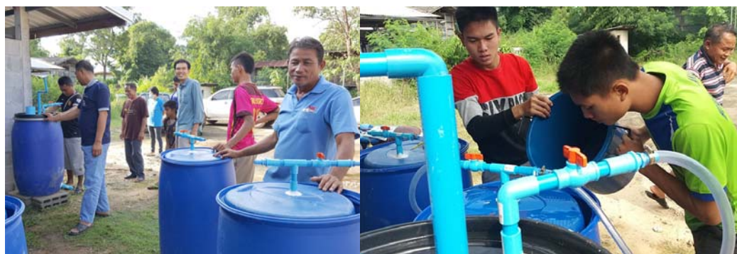
ภาพที่ 4-22 : ชุดทดลองกำเนิดแก๊สชีวภาพจากกระบวนการหมักเศษอาหาร
