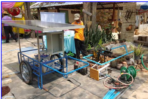
ภาพที่ 3-14 : ที่มิจัยทดลองประกอบชุดรถเข็นพลังงานแสงอาทิตย์
