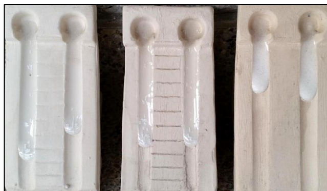
รูปที่ 145 การเปรียบเทียบการไหล (flowing) ของสูตรเคลือบผลึกที่มีการเติม \text{Al}_2\text{O}_3 ในสัดส่วนร้อยละ 0, 1 และ 5 โดยน้ำหนัก ตามลำดับ เคลือบถูกเผาที่ 1250^\circ\text{C}
