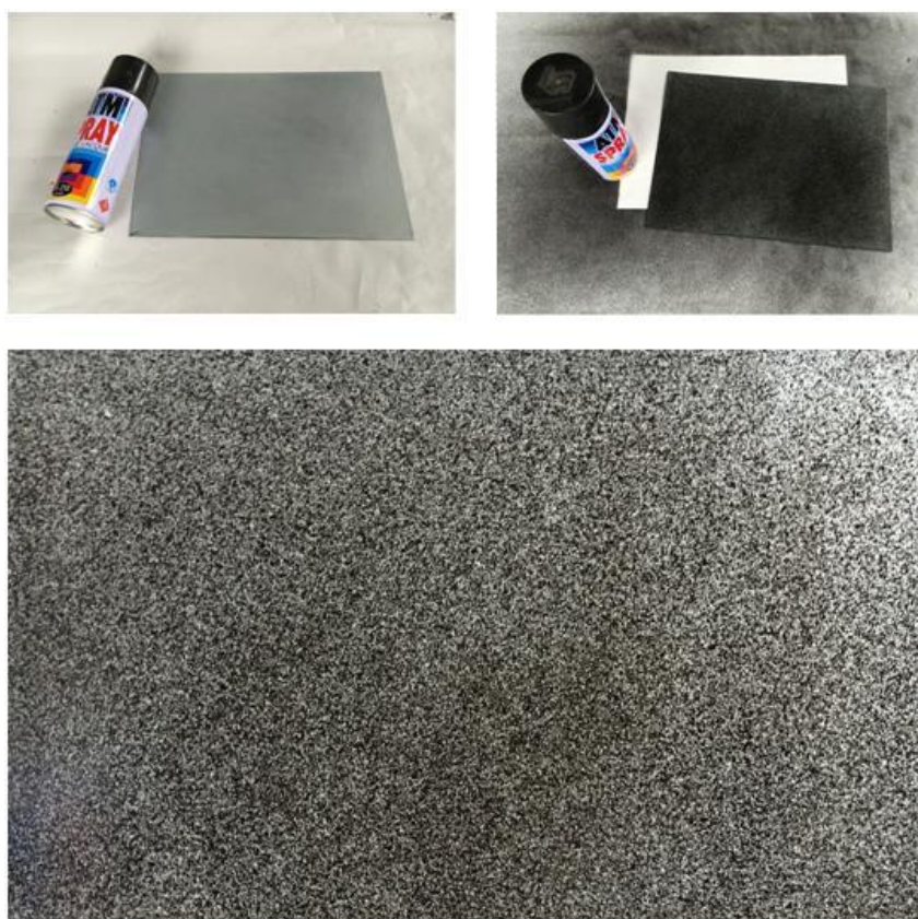
ภาพประกอบ 54 การใช้สเปรย์กระป๋องพ่นให้ทั่วผิวหน้าแผ่นแม่พิมพ์
