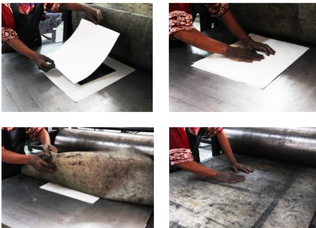
ภาพประกอบ 65 แสดงลำดับการวางแม่พิมพ์ กระจก และผ้ารองพิมพ์บนแท่นพิมพ์
