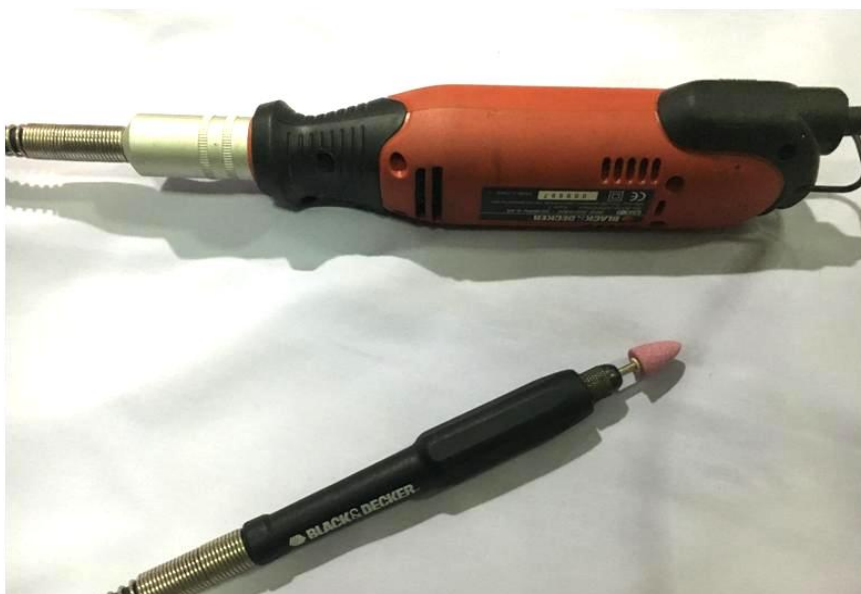
ภาพประกอบ 33 เครื่องเจียรขนาดเล็กที่ประยุกต์นำมาใช้สร้างสรรค์ผลงาน
