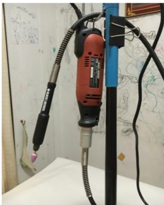
ภาพประกอบ 56 เครื่องเจียรขนาดเล็กที่ใช้ในการสร้างสรรค์ผลงาน
