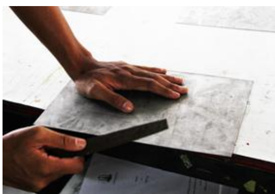
ภาพประกอบ 61 แสดงการตะไบขอบแม่พิมพ์โลหะ
