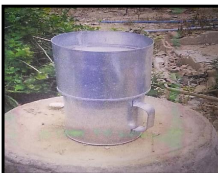
การติดตั้งเครื่องวัดปริมาณน้ำฝน
