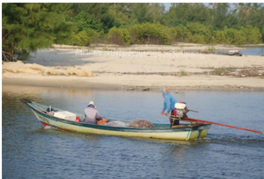
ภาพที่ 4.4 : ภาพเรือประมงที่ใช้เครื่องยนต์แบบหางยาวขนาดเล็ก
