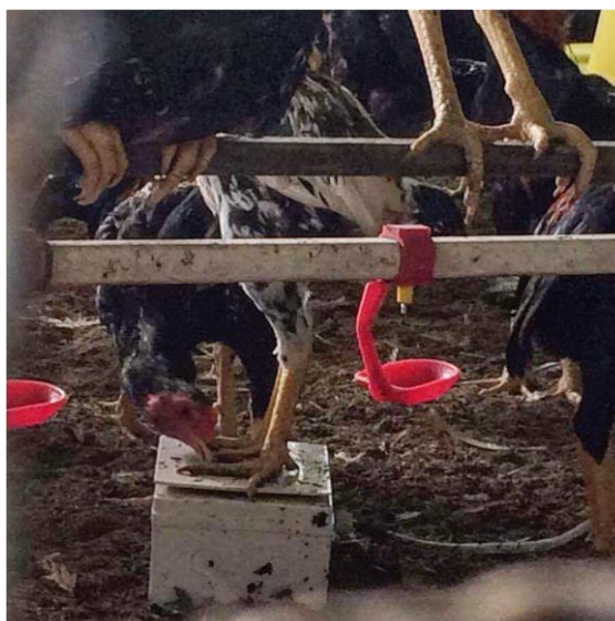
รูปที่ 4.2.3.2 การทดสอบการใช้งานต้นแบบเครื่องชั่งน้ำหนักไก่อัตโนมัติ ที่โรงเรียนวิจัยสัตว์ปีก 6 ฟาร์ม มหาวิทยาลัยเทคโนโลยีสุรนารี ไก่ภายในโรงเรียนมีทั้งไก่ตัวผู้และตัวเมีย เมื่อไก่อินบนเครื่องชั่งน้ำหนักประมาณ 4s เครื่องชั่งจะอ่านค่าน้ำหนัก
