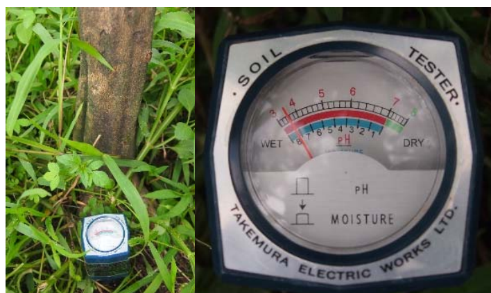
รูปที่ 34. เครื่อง pH meter แบบพกพา ยี่ห้อ Takemura รุ่น DM-13
