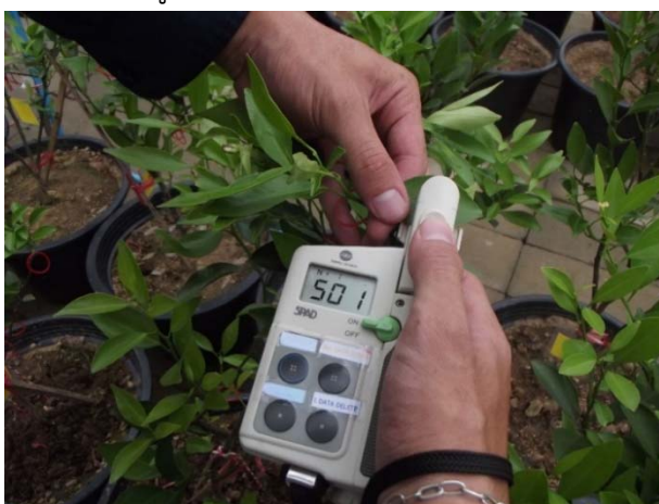
รูปที่ 27. เครื่อง chlorophyll meter ยี่ห้อ Minolta รุ่น SPAD502
