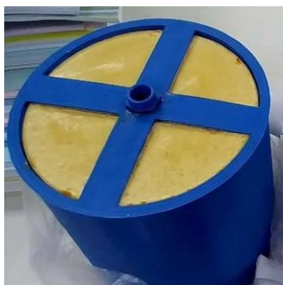
ภาพ 60 หุ่นจำลองสีระชะและลำคอรูปทรงกระบอก ขนาดเส้นผ่านศูนย์กลาง 16 เซนติเมตร และความสูง 20 เซนติเมตร ภายในบรรจุยางพารา
