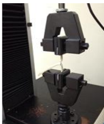
ภาพที่ 23 แสดง Trouser Test Specimen สำหรับการทดสอบด้วยเครื่องมือ Tensile Testing
