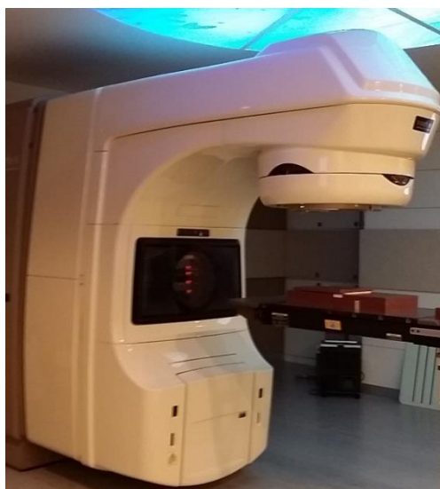
ภาพที่ 25 การฉายรังสีตัวอย่างชิ้นงานด้วยเครื่องเร่งอนุภาค (LINAC) MV ใน solid water phantom อัตราปลดปล่อยรังสี 300 cGy/MU ความกว้างลำรังสี 30x30 ตารางเซนติเมตร ระยะต้นกำเนิดรังสีถึงวัสดุสมมูลเนื้อเยื่อเท่ากับ 95 เซนติเมตร วางชิ้นงานยางพาราที่ระยะความลึกจากผิววัสดุสมมูลเนื้อเยื่อเท่ากับ 5 เซนติเมตร
