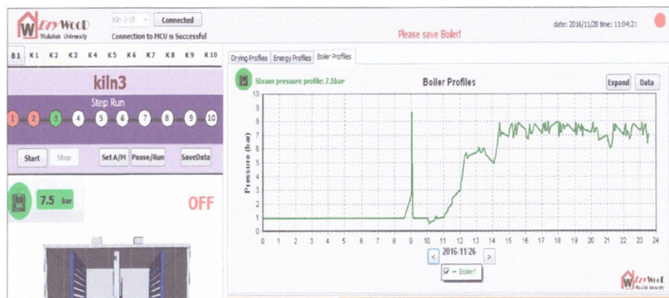
รูปที่ 5.18 การใช้งานระบบเพื่อแสดงค่าความดันไอน้ำที่ผลิตจากบอยเลอร์ของบริษัทนครศรีพาราวัฏ จำกัด จังหวัดนครศรีธรรมราช
