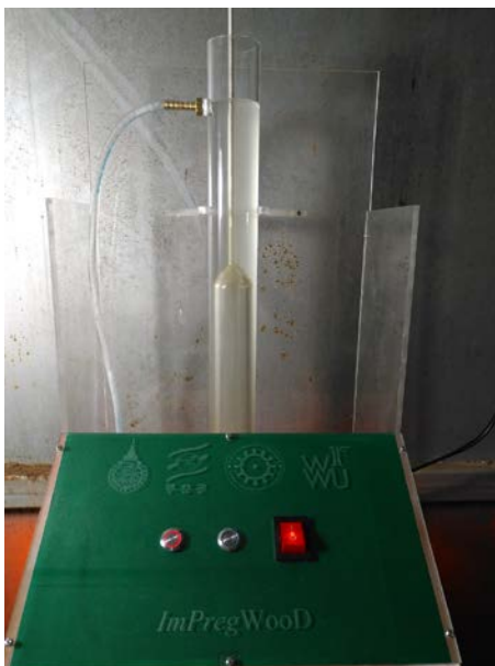
รูปที่ 4.14 ระบบวัดความเข้มข้นน้ำยาแบบอัตโนมัติขณะกำลังถ่ายสารละลายโบรอนจากถังเก็บ เพื่อการอ่านค่าความเข้มข้นน้ำยาต่อไป
