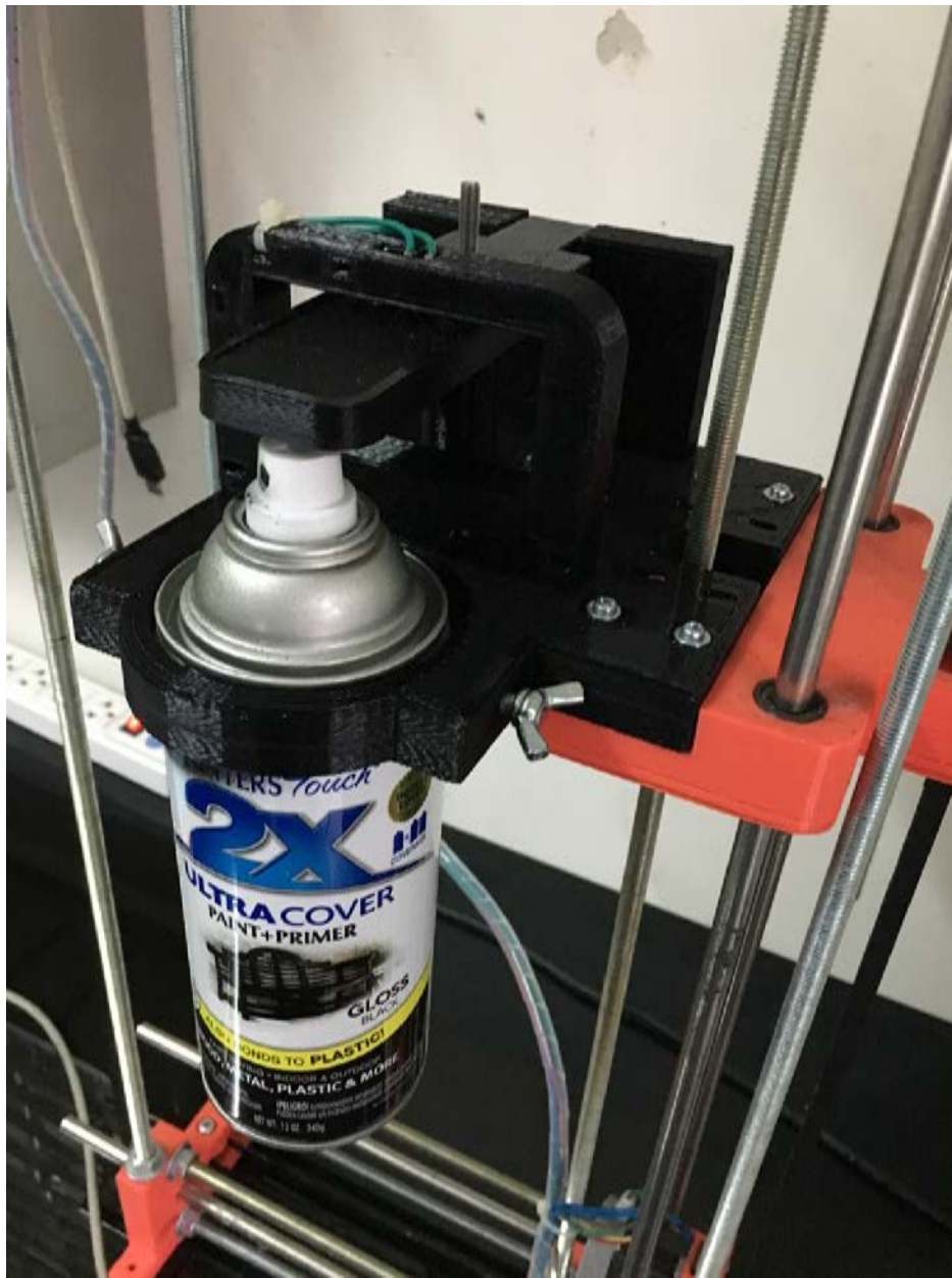
รูปที่ 3.24 ภาพถ่ายของกลไกควบคุมการฉีดสี
