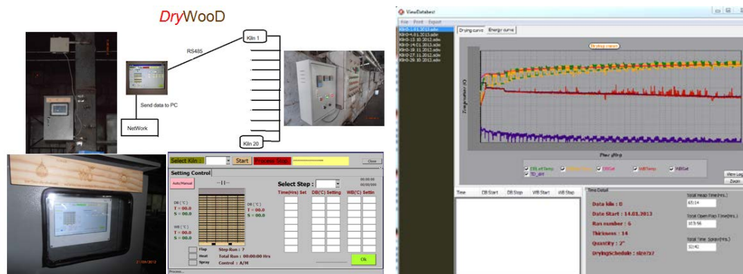
รูปที่ 2.16 ระบบควบคุมการอบไม้อัตโนมัติที่พัฒนาขึ้นซึ่งติดตั้งเข้ากับเตาอบไม้ยางพาราของโรงงานแห่งหนึ่งในพื้นที่จังหวัดนครศรีธรรมราช
