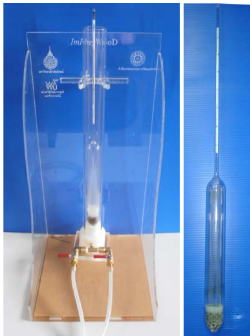
รูปที่ 4.1 ระบบวัดความเข้มข้นของน้ำยา ImPregWood เดิมที่มีการถ่ายน้ำยาเข้าออกด้วยคนและไม่มีระบบทำความสะอาดตัวเองหลังการใช้งาน
