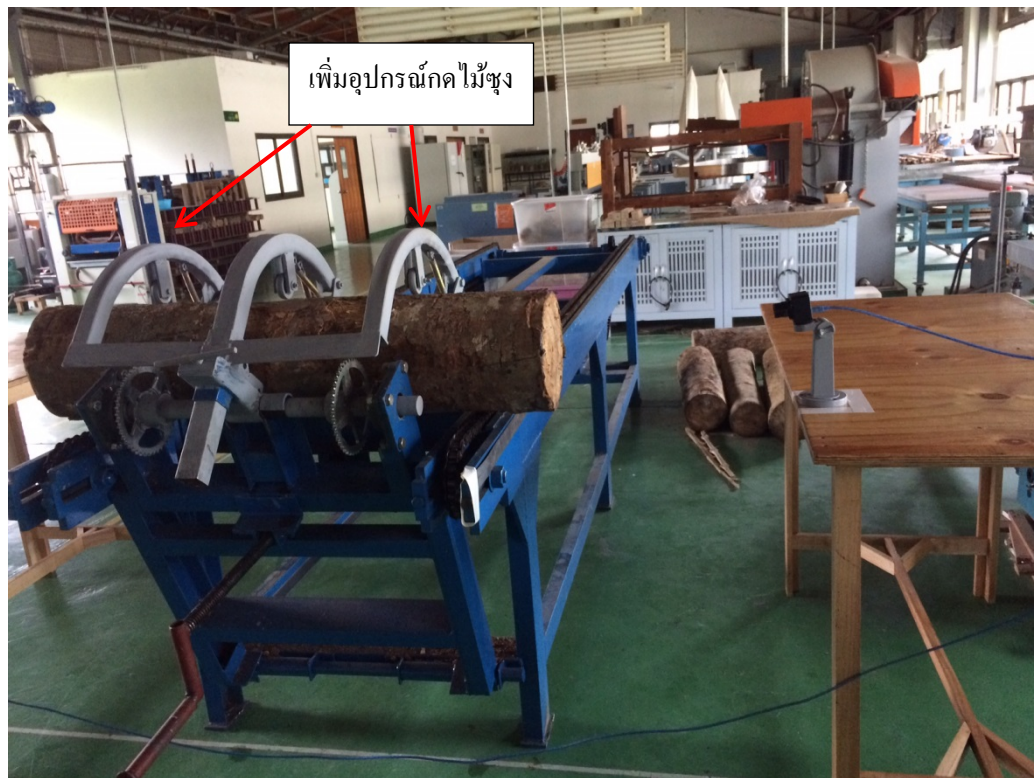
รูปที่ 3.33 เครื่องหมุนไม้ซุงหลังจากเพิ่มตัวกดไม้ซุงเพื่อป้องกันการกลิ้งออกจากเฟือง
