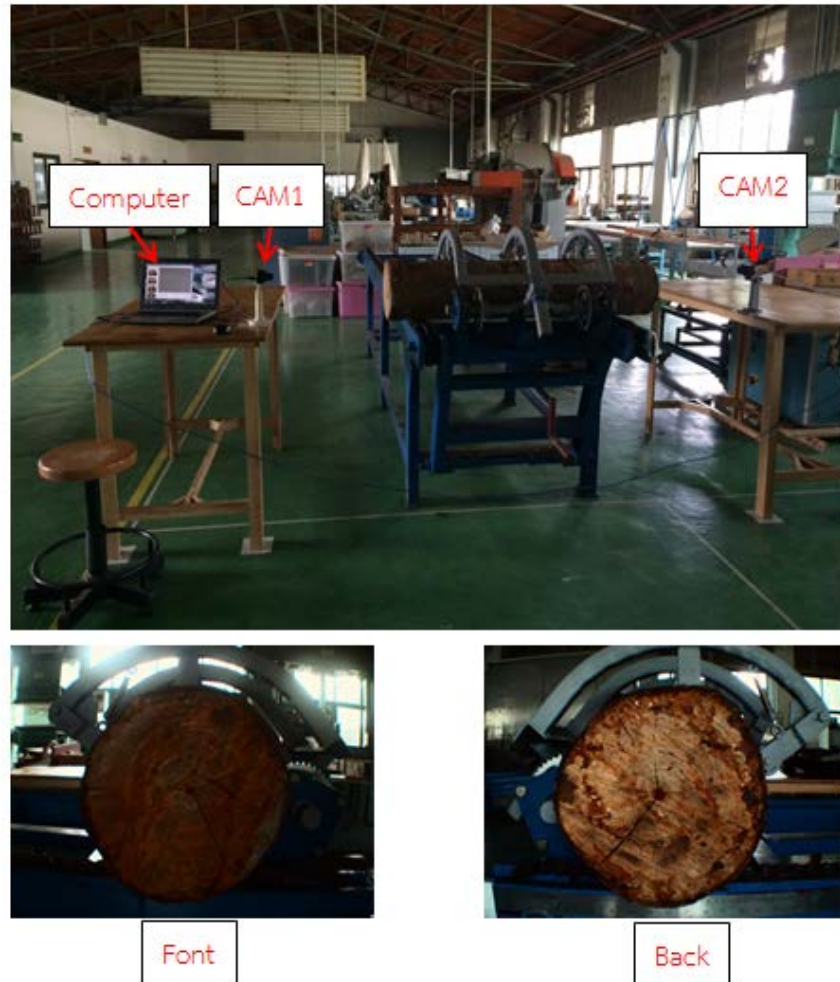
รูปที่ 3.18 การวางแผนกล้องถ่ายรูปหน้าไม้ โดยทำการกำหนดระยะจากเลนส์ถึงเครื่องเลื่อยไม้แล้วทดสอบกระบวนการหาแนวไม้ด้วยคอมพิวเตอร์
