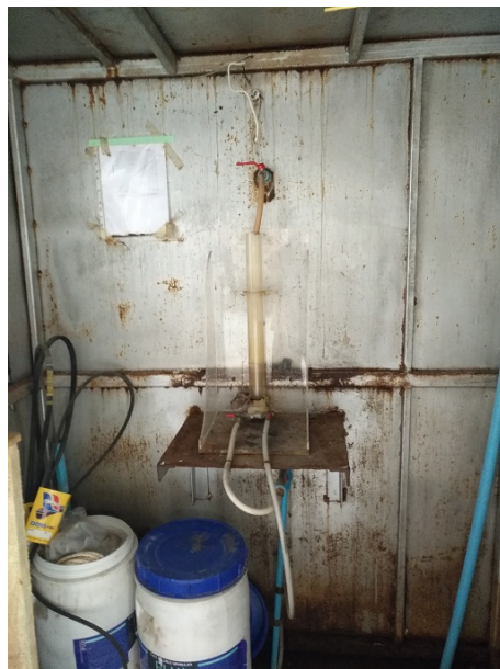
รูปที่ 4.13 ระบบควบคุมความเข้มข้นน้ำยาแบบเดิมที่ เปิด - ปิด น้ำยาด้วยมือที่ผ่านการใช้งาน มาตั้งแต่ปี 2556 และระบบควบคุมความเข้มข้นน้ำยาแบบอัตโนมัติที่ติดตั้งใหม่
