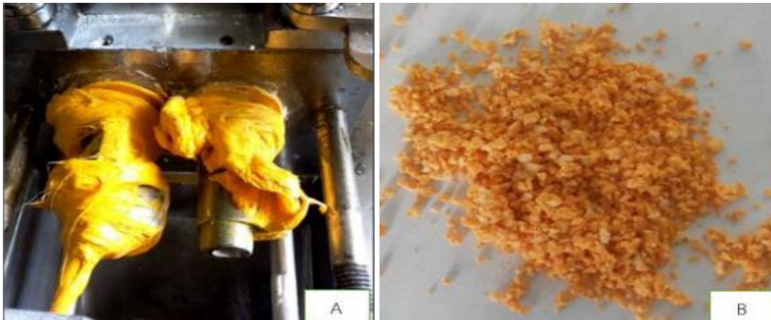
รูปที่ 1 พอลิเมอร์เบลนด์สำหรับใช้เป็นสารยึดเกาะในการเตรียมวัสดุเทอร์โมพลาสติกสำหรับทำเครื่องหมายบนผิว ทาง A = ระหว่างทำการเบลนด์ B = หลังจากบดให้เป็นผง
