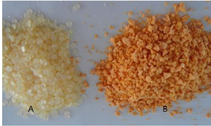
รูปที่ 3 เปรียบเทียบลักษณะความแตกต่างระหว่างไฮโดรคาร์บอนเรซิน (A) และพอลิเมอร์เบลนด์ (B) ที่ใช้สำหรับเตรียมเป็นสารยัดเกาะในวัสดุเทอร์โมพลาสติกสำหรับทำเครื่องหมายบนผิวทางทางการค้าและในงานวิจัยนี้ ตามลำดับ
