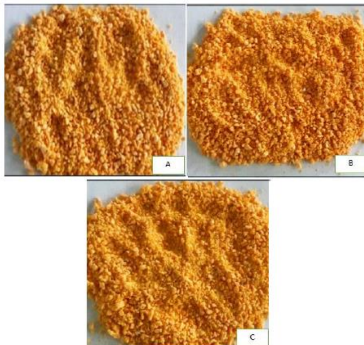
รูปที่ 2 พอลิเมอร์เบลนด์ที่ใช้สำหรับเป็นสารยึดเกาะในการเตรียมวัสดุเทอร์โมพลาสติกสำหรับทำเครื่องหมายบนผิว ทางที่ผสมยางธรรมชาติในปริมาณร้อยละ 15 (A), 10 (B) และ 5 (C)
