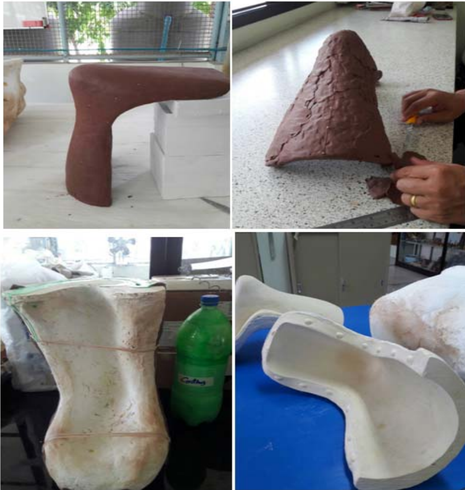
แผนภาพที่ 4.2 แสดงการขึ้นแม่พิมพ์จากดินน้ำมัน
