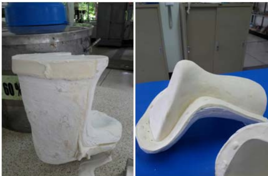
แผนภาพที่ 4.3 แสดงการทดสอบแม่พิมพ์และสูตรยาง ด้วยการเทยางพารา
