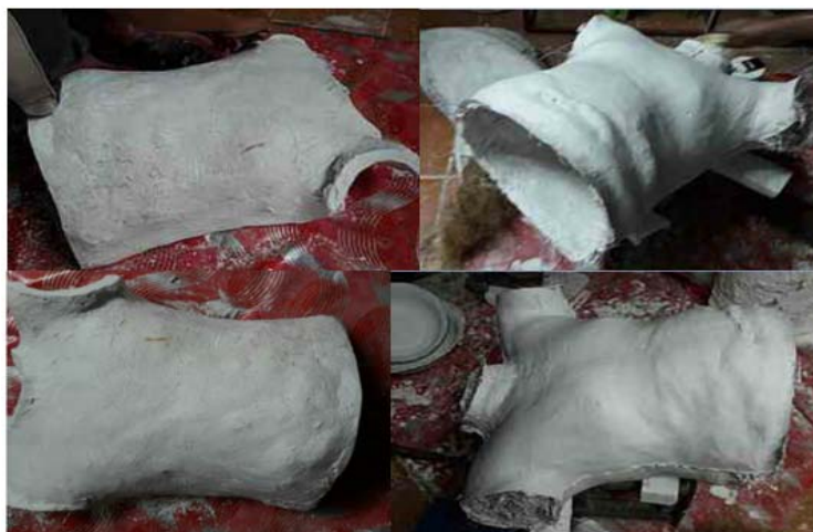
แผนภาพที่ 4.1 แสดงการขึ้นรูปแม่พิมพ์โครงสร้างลำตัว
