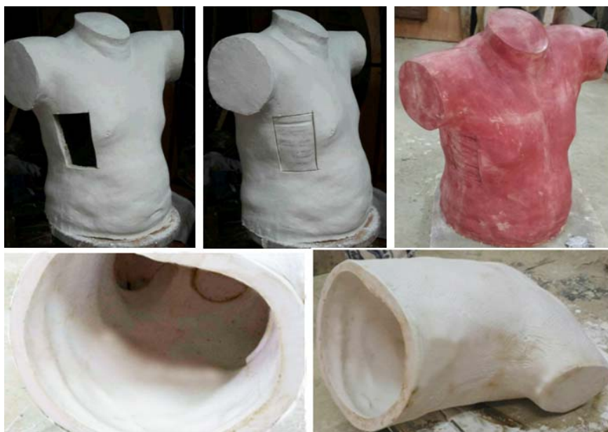
แผนภาพที่ 4.2 แสดงการขึ้นรูปแม่พิมพ์โครงสร้างลำตัวและช่องปอดภายนอก
