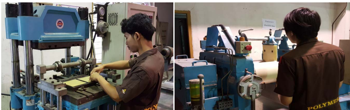
แผนภาพที่ 4.3 แสดงขั้นตอนการขึ้นรูปและรีดยางแผ่นจากยางธรรมชาติ
