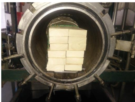
ภาพที่ 5 แสดงการนำชิ้นไม้เข้าเครื่องอัดน้ำยาเพื่ออัดกาว
