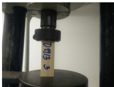
รูปภาพที่ 19 แสดงการทดสอบความเค้นอัดขนานเส้น
