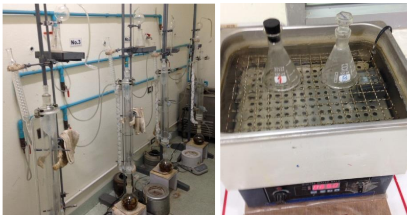
ภาพที่ 25 ชุดอุปกรณ์ในการทดสอบปริมาณฟอร์มาลดีไฮด์ ตามมาตรฐาน EN 120:1992
