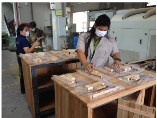
ภาพที่ 14 การตัดชิ้นทดสอบเพื่อทดสอบค่าคุณสมบัติทางฟิสิกส์และทางกล ตามมาตรฐานต่างๆ
