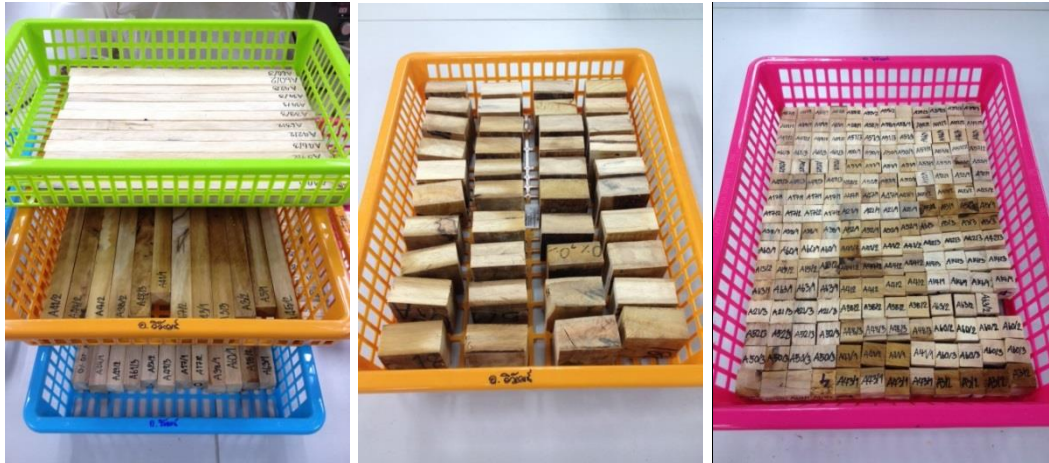
ภาพที่ 15 แสดงการปรับสภาวะชื้นทดสอบ
