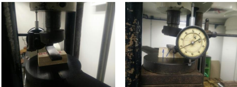
รูปภาพที่ 18 แสดง การทดสอบความเค้นอัดตั้งฉากเส้น
