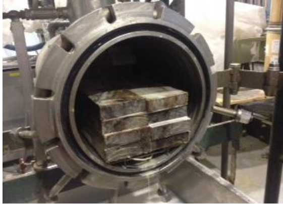
ภาพที่ 7 ไม้ยางพาราที่ผ่านการอัดกาเข้าไปในเนื้อไม้
