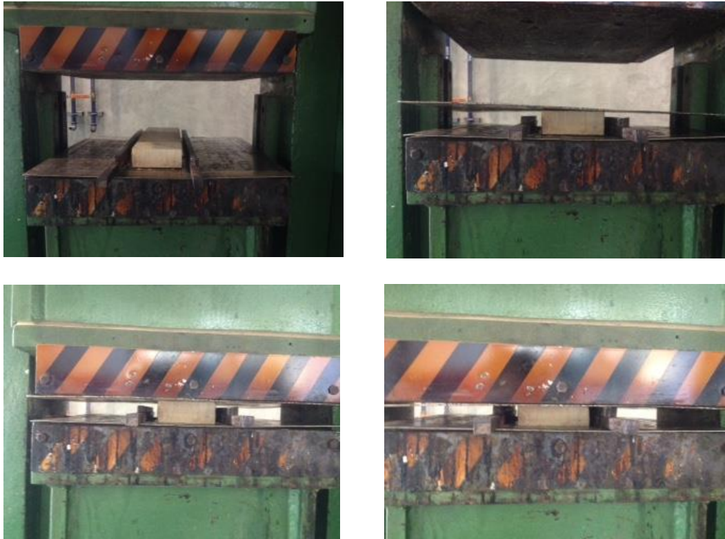
ภาพที่ 11 แสดงการอัดร้อนขึ้นไม้ทดลอง
