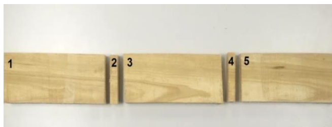
ภาพที่ 3 แสดงการตัดชิ้นไม้ทดสอบ
