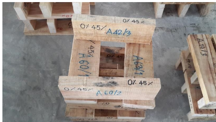
ภาพที่ 8 ไม้ยางพาราที่ผ่านการอัดกาเข้าไปในเนื้อไม้
