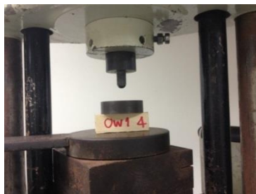
รูปภาพที่ 21 แสดงการทดสอบความแข็งของชิ้นทดสอบ
