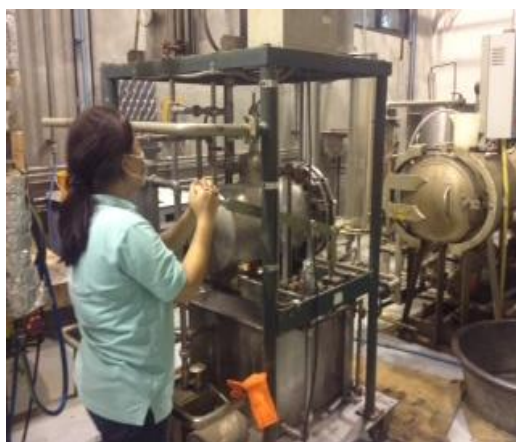
ภาพที่ 6 การอัดกาวเข้าไปในเนื้อไม้ด้วยแรงอัด
