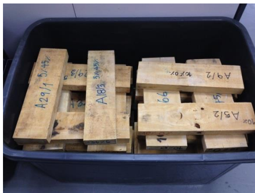
ภาพที่ 12 การผึ่งไม้ในห้องควบคุมความชื้น
