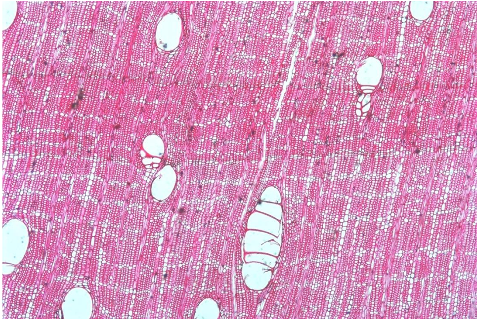
ภาพที่ 2 ลักษณะโครงสร้างทางกายวิภาคของไม้ยางพาราอย่างละเอียด
