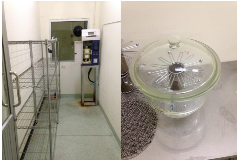
ภาพที่ 24 ชุดอุปกรณ์และห้องควบคุมอุณหภูมิที่ใช้ในการทดสอบการปลดปล่อยฟอร์มัลดีไฮด์ตามมาตรฐาน JIS
