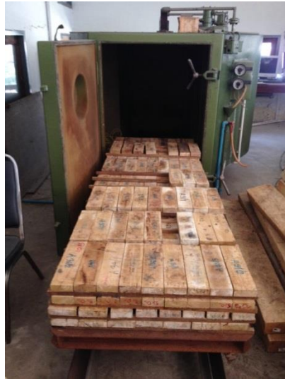
ภาพที่ 9 ทำการอบไม้ยางพาราอัดกาวเพื่อควบคุมสถานะความชื้น
