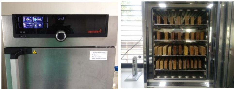
ภาพที่ 10 แสดงการอบร้อนชิ้นไม้ทดลองเพื่อให้กาวแข็งตัว
