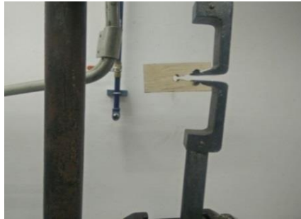
รูปภาพที่ 22 แสดงการทดสอบการฉีกของไม้
