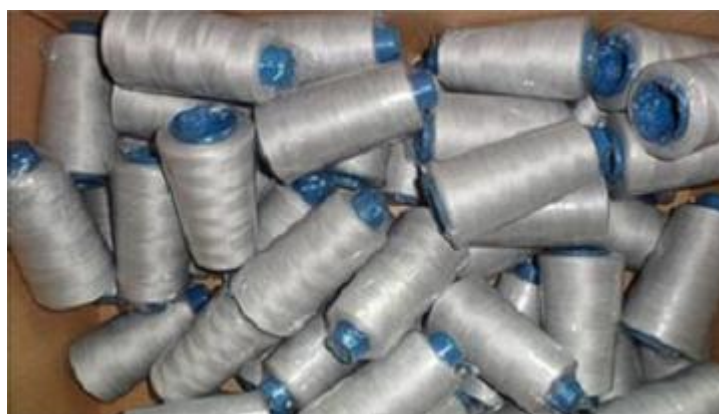
ภาพที่ 21 เส้นใยนำไฟฟ้าจากการผสมเส้นใยคาร์บอนลงในเส้นใยกลุ่มอุตสาหกรรมอีกทอ
