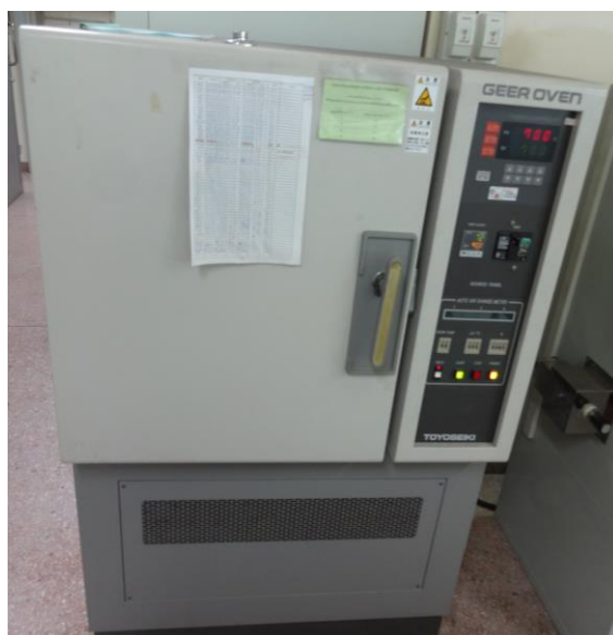
รูปที่ 2.2 Geer oven Toyoseiki Model ACR-45A สำหรับการบ่มแรงตัวอย่างถุงมือยาง
