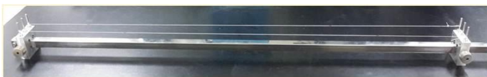
รูปที่ 2.5 อุปกรณ์สำหรับการทดสอบการยึดอยู่ตัว (Tension set)
