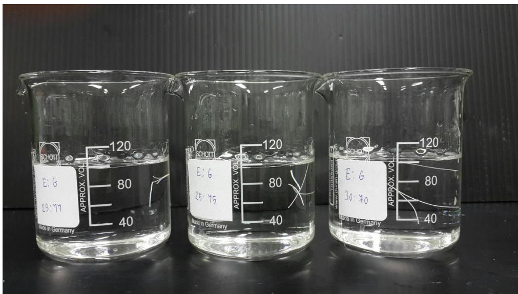
รูปที่ 3.1 เส้นด้ายยาง C1/90 ที่ทดสอบตาม ISO 2321:2006 Method A
