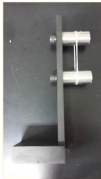
รูปที่ 2.3 เครื่องม้วนเป็นวง (Loop forming machine)
