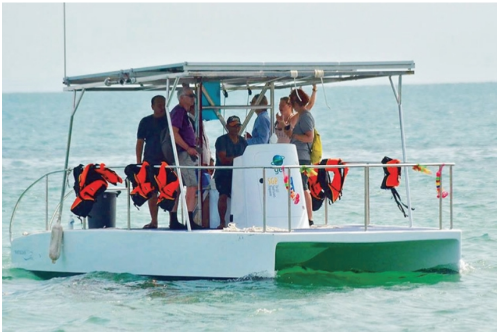
รูปที่ 2.4 เรือ “แสงสุวรรณ” พลังงานแสงอาทิตย์
