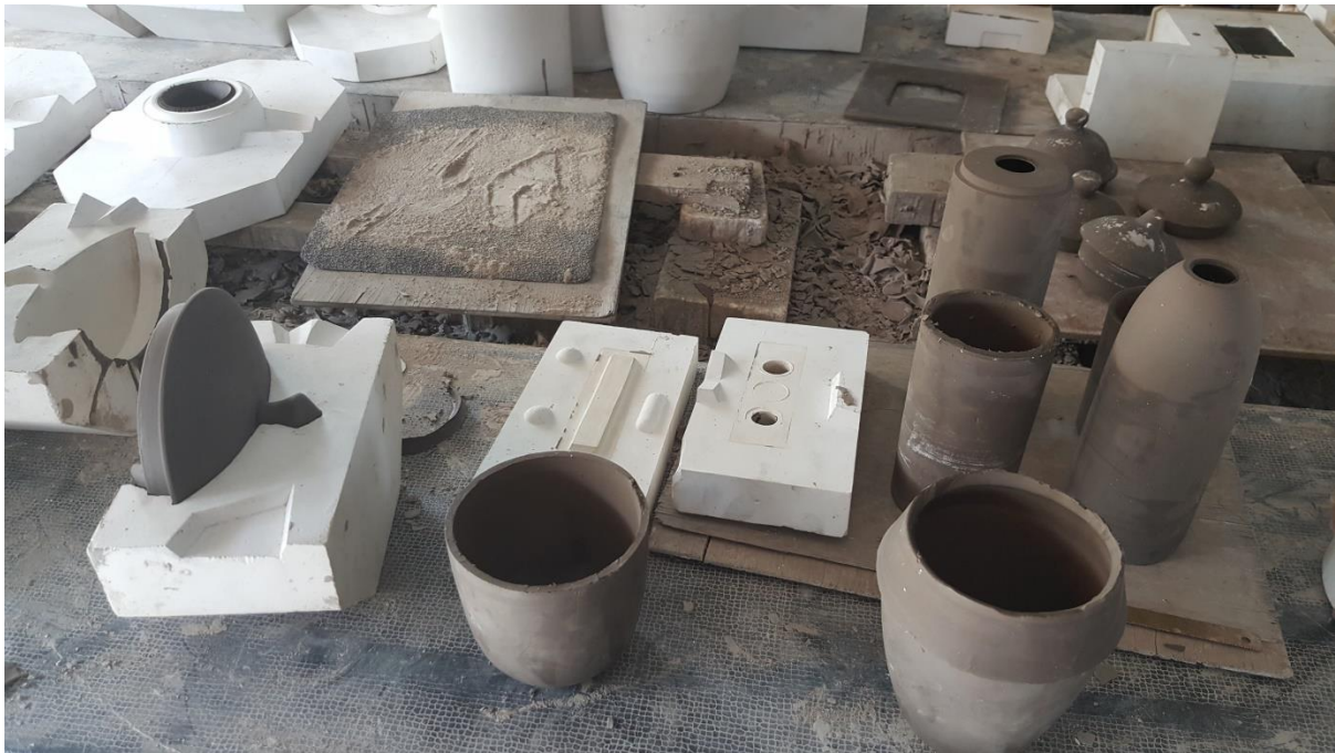
ภาพที่ 05 แสดงการทดลองหล่อชิ้นงานโดยพิมพ์ต้นแบบ
