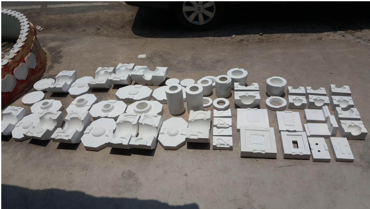
ภาพที่ 6.1 แสดงพิมพ์ต้นแบบทำการทดลองหล่อชิ้นงาน
