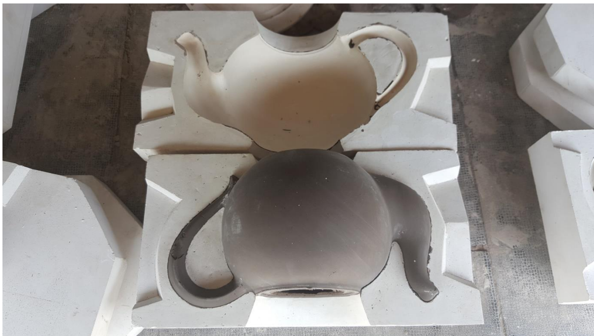
ภาพที่ 03 แสดงการทดลองหล่อชิ้นงานโดยพิมพ์ต้นแบบ
