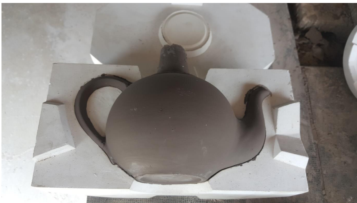
ภาพที่ 04 แสดงการทดลองหล่อชิ้นงานโดยพิมพ์ต้นแบบ
