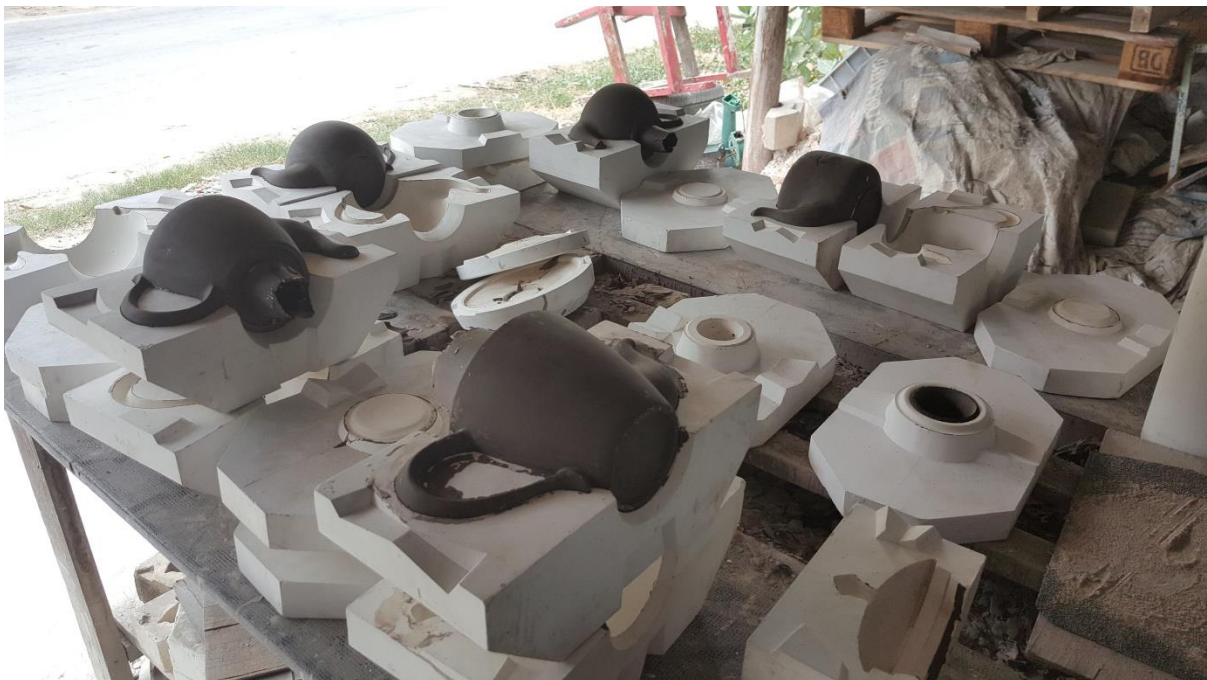
ภาพที่ 06 แสดงการทดลองหล่อชิ้นงานโดยพิมพ์ต้นแบบ
