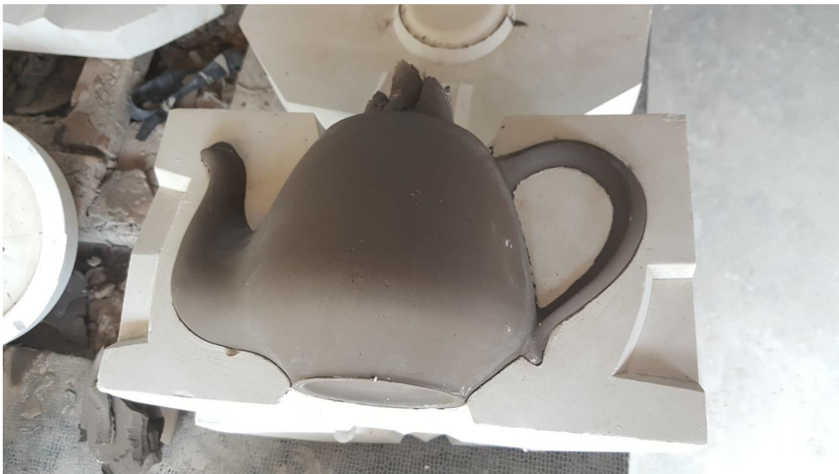
ภาพที่ 02 แสดงการทดลองหล่อชิ้นงานโดยพิมพ์ต้นแบบ
