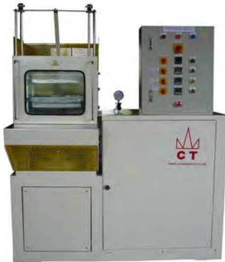
รูปที่ 1.10: เครื่องกดอัด (Compression Molding Machine)
