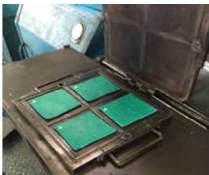
รูปที่ 1.18: กระบวนการขึ้นรูปชิ้นงานด้วยแม่พิมพ์
