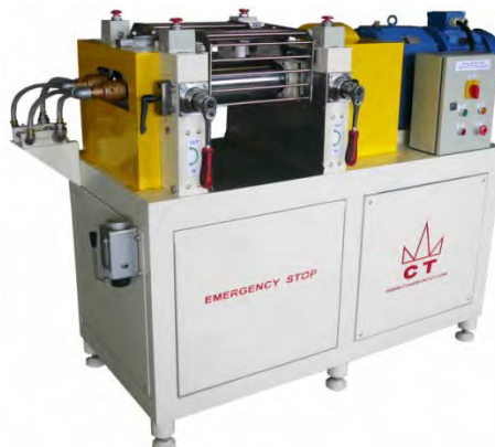
รูปที่ 1.6: เครื่องผสมสองลูกกลิ้ง (Two roll mill)
