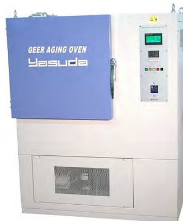
รูปที่ 1.14: ตู้ทดสอบสภาวะเร่งของชิ้นงาน (Aging Oven)
