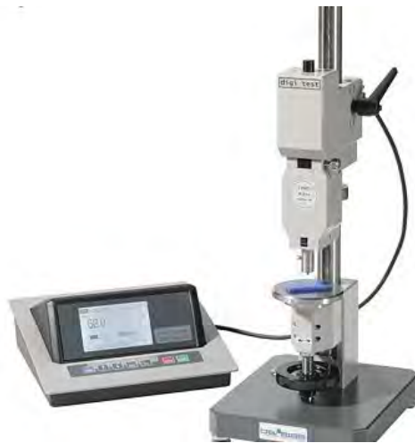
รูปที่ 1.12: เครื่องวัดความแข็ง (Universal Hardness Tester)
