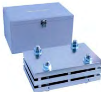
รูปที่ 1.15: เครื่องทดสอบคุณสมบัติการบีบอัด (Compression Set Tester)
