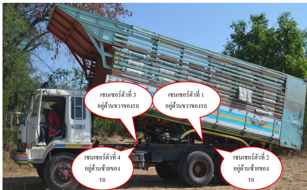
รูปที่ 3.9 แผนภาพการติดตั้งเซนเซอร์แบบ 2 ตัว(บน)และเซนเซอร์แบบ 4 ตัว(ล่าง)
