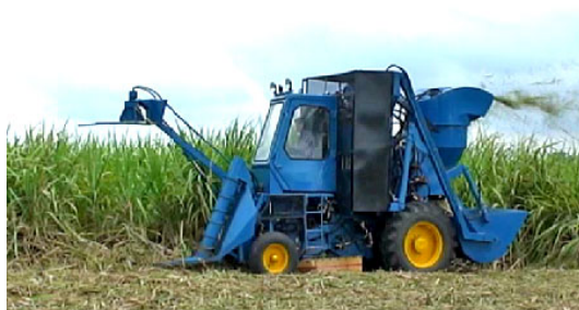
รูปที่ 2.7 รถตัดอ้อยชนิดที่ไม่มีชุดระบบลำเลียง (elevator) (ที่มา : สำนักงานคณะกรรมการอ้อยและน้ำตาลทราย, 2551)
