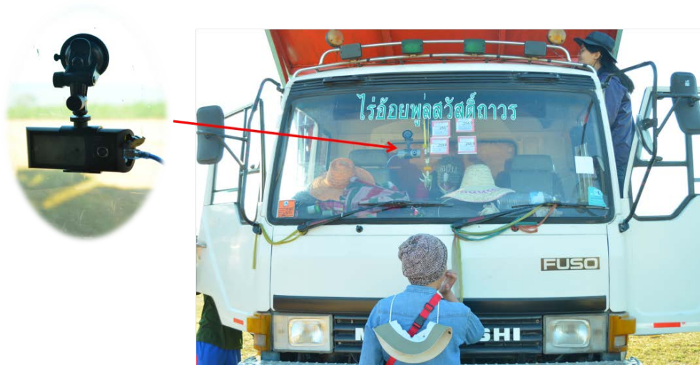
รูปที่ 3.6 จุดติดตั้งกล้องบันทึกภาพเคลื่อนไหว R300
