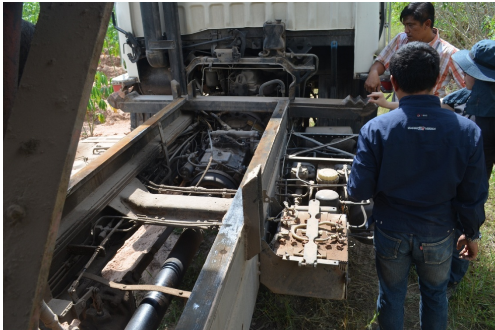
รูปที่ 4.7 การวัดโครงสร้างแชสซีของรถบรรทุกที่ใช้ในการทดสอบ
