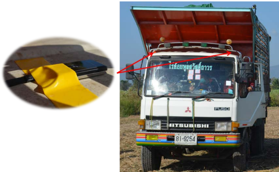
รูปที่ 3.7 จุดติดตั้งเครื่องบันทึกตำแหน่งภูมิศาสตร์ (GPS Logger)
