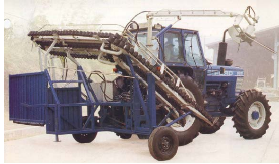
รูปที่ 2.3 เครื่องเก็บเกี่ยวอ้อยแบบติดพ่วงกับรถแทรกเตอร์ (ที่มา: สุกรี นันทะสุคนธ์ และ อรรถสิทธิ บุญธรรม [11])
