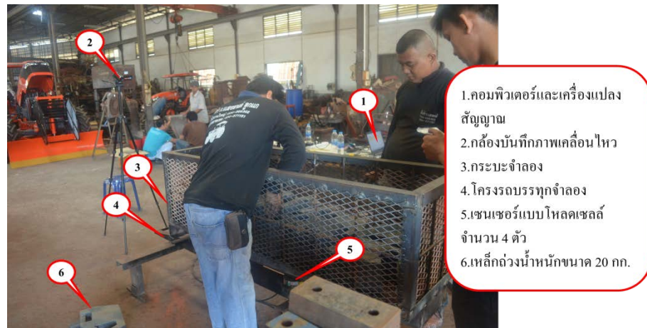
รูปที่ 4.29 การติดตั้งอุปกรณ์ในการทดสอบระบบวัดน้ำหนักของเซนเซอร์ในตำแหน่งที่ติดตั้งแบบ 2 ตัว และ แบบ 4 ตัว
