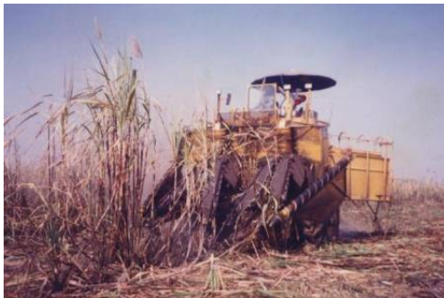
รูปที่ 2.2 เครื่องเก็บเกี่ยวอ้อยแบบเกี่ยวตัดทั้งต้น (ที่มา : สุกรี นันทะสุนันท์ และ อรรถสิทธิ บุญธรรม [11])
