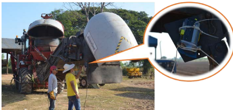
รูปที่ 3.1 จุดติดตั้งกล้องบันทึกภาพเคลื่อนไหว (VDO) ยี่ห้อคอนทัวร์ (Contour)
