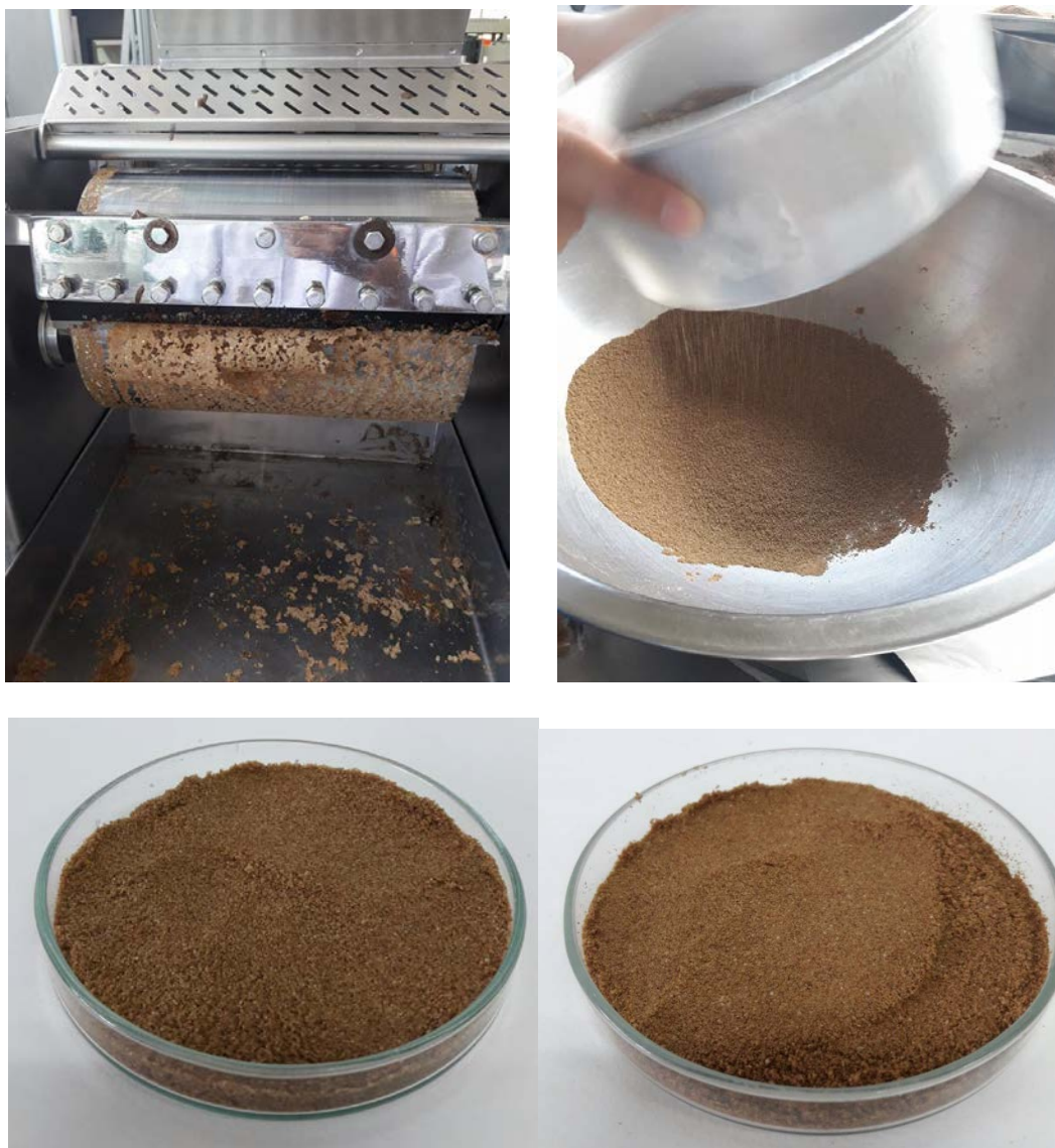
ภาพที่ 34 ขั้นตอนการทำปลาร้าผงโดยการทำแห้งแบบบลูกกลิ้งคู่
