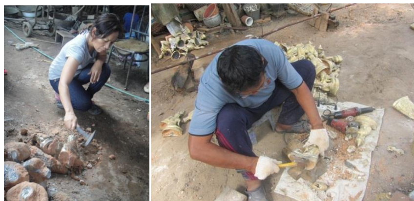
(11) ทูบแบบดูว่าทองเหลืองไหลเต็มแบบ งานสมบูรณ์เรียบร้อยดีหรือไม่ ถ้าไม่ก็นำไปเชื่อมซ่อมแซมส่วนที่ชำรุดและตกแต่งงานให้เรียบร้อย
