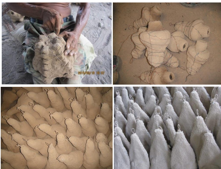
(9) นำไปเผาด้วยความร้อนสูงประมาณ 2 ชั่วโมงแบบพิมพ์เทียนจะไหลออกเหลือแต่เพียงแบบพิมพ์ดินอยู่ภายใน
