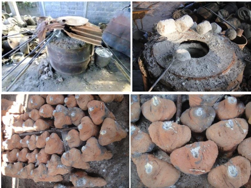
(11) ทูบแบบดูว่าทองเหลืองไหลเต็มแบบ งานสมบูรณ์เรียบร้อยดีหรือไม่ ถ้าไม่ก็นำไปเชื่อมซ่อมแซมส่วนที่ชำรุดและตกแต่งงานให้เรียบร้อย
