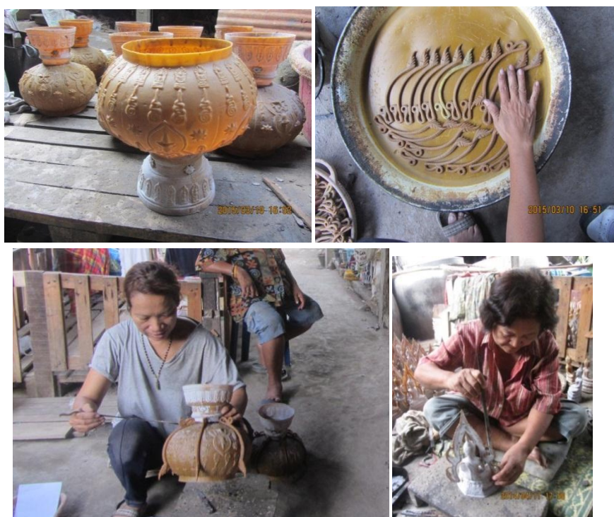
(4) ทาแบบเขียนด้วยดินนวล (ส่วนผสมของขี้วัว ดินจอมปลวก และขี้เถ้าแกลบ ปั่นให้ละเอียดจนเป็นฝุ่น กรองหลายครั้ง แล้วผสมน้ำ) ใช้แปรงทา 2 ครั้ง (วันละครั้ง) แล้วผึ่งไว้ในร่มจนแห้งสนิท
