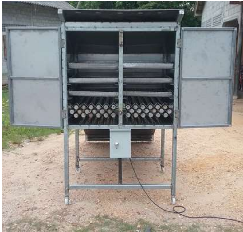
ภาพที่ 4.3 ภาพเครื่องอบแห้งพลังงานความร้อนร่วมจากแสงแดดร่วมพลังงานรังสีอินฟราเรด ผลการอบแห้งของลูกหอย
