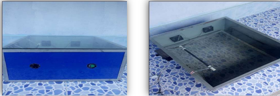
ภาพที่ 4.2 ภาพแสดงเครื่องอบแห้งด้วยพลังงานความร้อนร่วมแสงอาทิตย์กับรังสีอินฟราเรดขนาดทดลอง
