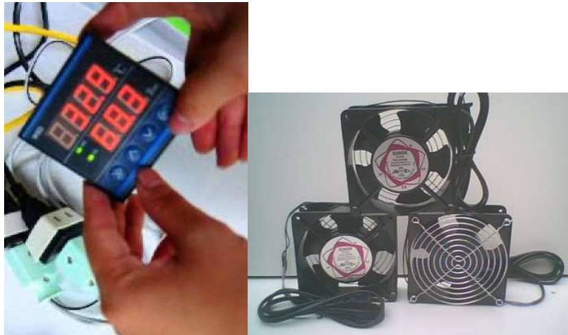
ภาพที่ 4.9 วงจรควบคุมอุณหภูมิและความชื้นที่ต่อพ่วงกับพัดลมระบายอากาศ
