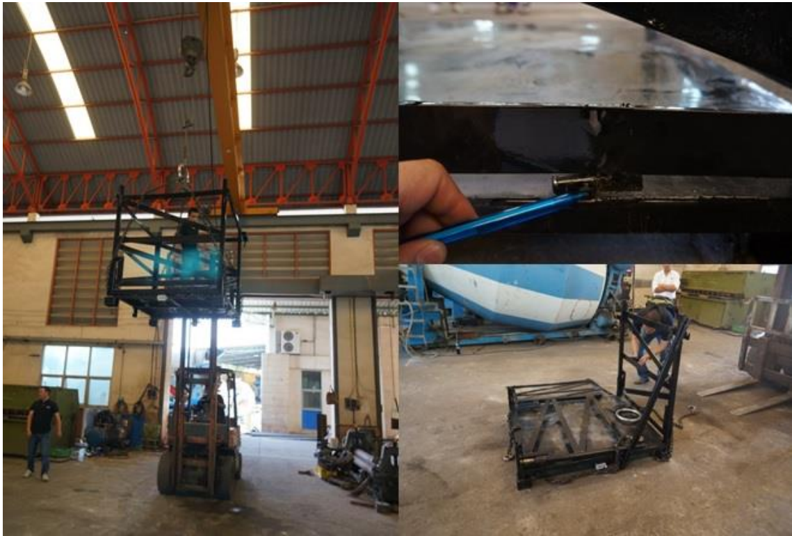
ภาพที่ 45 การทดสอบปล่อยตกอิสระ
