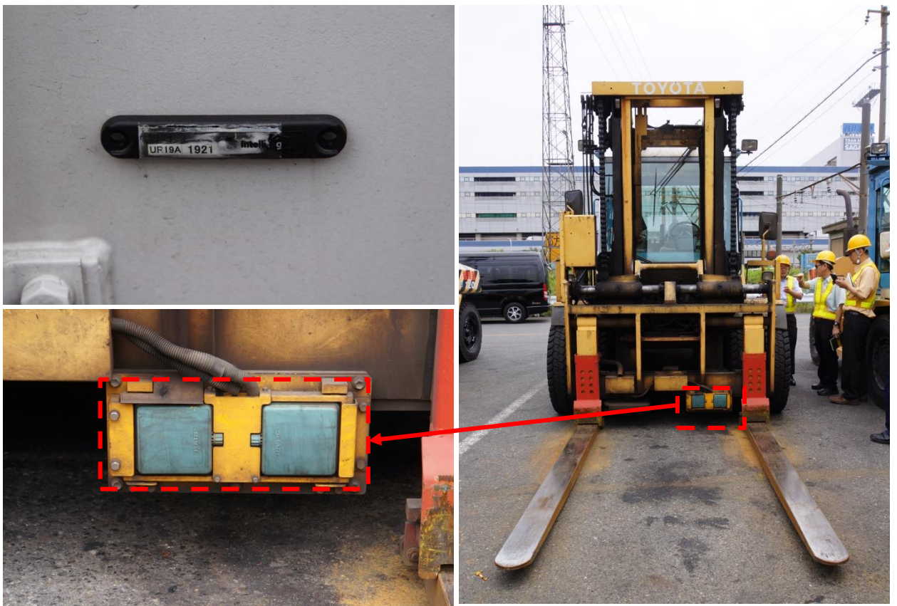
ภาพที่ 23 RFID Tag และ RFID Reader ที่รถโฟล์คลิฟท์
