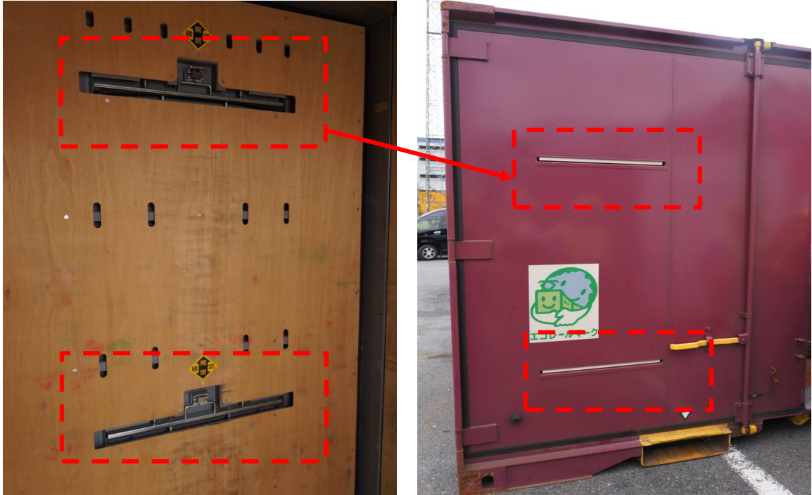
ภาพที่ 22 ช่องระบายอากาศ ภายใน (ซ้าย) และภายนอก (ขวา)
