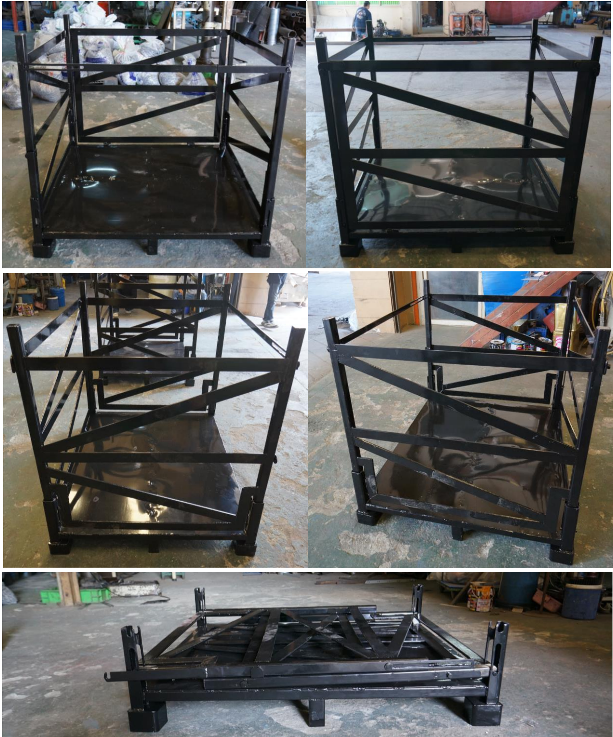
ภาพที่ 43 ต้นแบบอุปกรณ์ขนถ่ายสินค้าสำหรับการขนส่งต่อเนื่องหลายรูปแบบ รุ่นที่ 2
