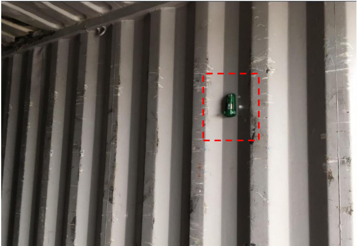
ภาพที่ 33 ตัวอย่างการติดตั้ง Vibration data logger ในตู้คอนเทนเนอร์
