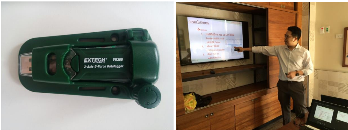
ภาพที่ 31 การแนะนำการติดตั้งและใช้งาน Vibration data logger รุ่น VB300
