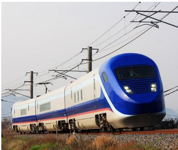
ภาพที่ 13 ตัวอย่างรถไฟเปลี่ยนขนาดรางได้ Gauge Change Train รุ่น GCT01-201
