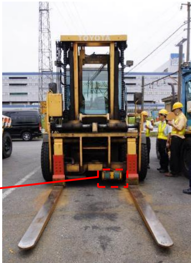
รูปที่ 9 RFID Tag และ RFID Reader ที่รถโฟล์คลิฟท์
