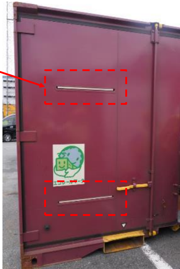
รูปที่ 8 ช่องระบายอากาศ ภายใน (ซ้าย) และภายนอก (ขวา)
