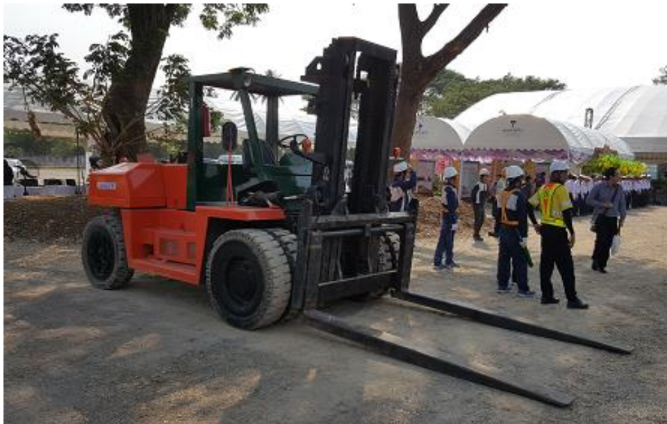
ภาพที่ 51 รถโฟล์คลิฟท์ สำหรับใช้ในการตักตู้สินค้าขึ้นบนแคร่รถไฟ
