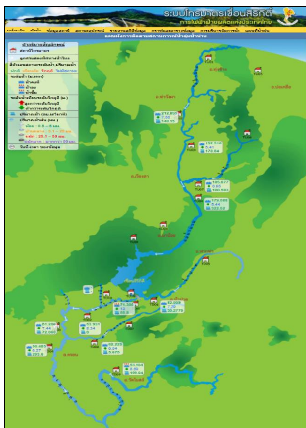
ภาพที่ 2-7 ภาพรวมของระบบโทรมาตรเพื่อติดตามข้อมูลปริมาณน้ำในกลุ่มน้ำน่านของเขื่อนสิริกิติ์
