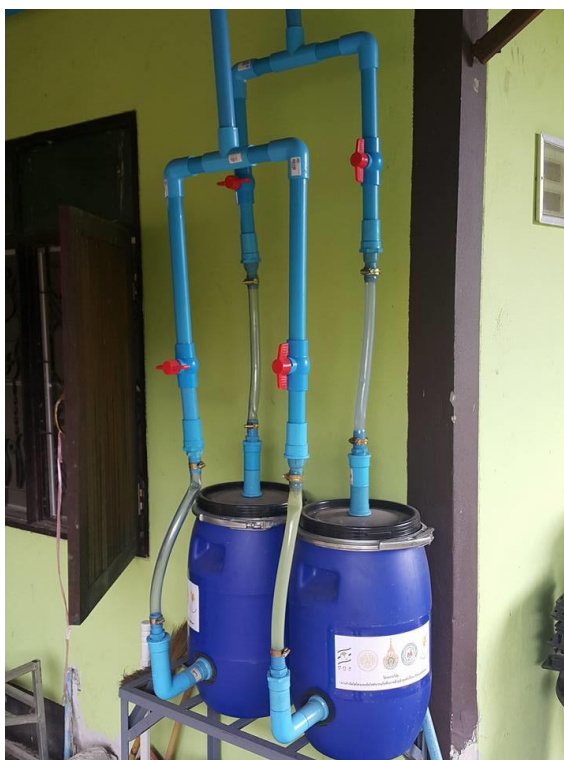
รูปที่ 6 แผงทดสอบการดูดซับแก๊สไฮโดรเจนซัลไฟด์ที่ถูกสร้างขึ้นที่วิสาหกิจชุมชนทองม้วนเปรมชัย
