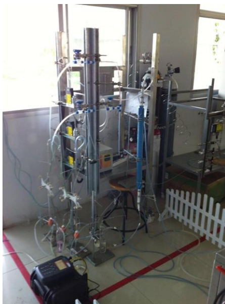
รูปที่ 4 แผงทดสอบการดูดซับแก๊สไฮโดรเจนซัลไฟด์ที่ถูกสร้างขึ้นในห้องปฏิบัติการวิจัย
