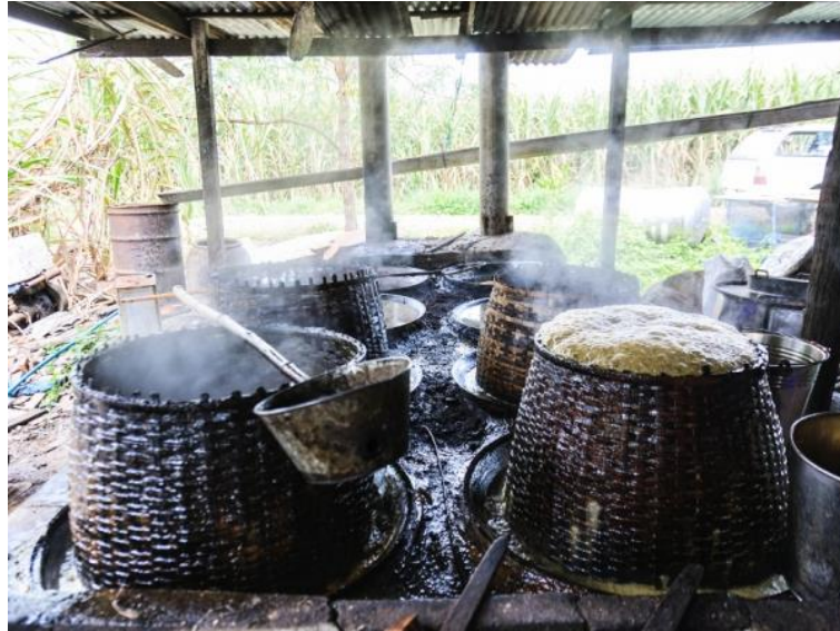
ภาพประกอบที่ ๔๖ การสุ่มไฟต้มน้ำอ้อยในโรงหนีบอ้อย
