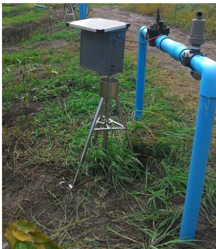
ภาพที่ 18 โหนดควบคุมวาล์วจ่ายน้ำ (VS)
