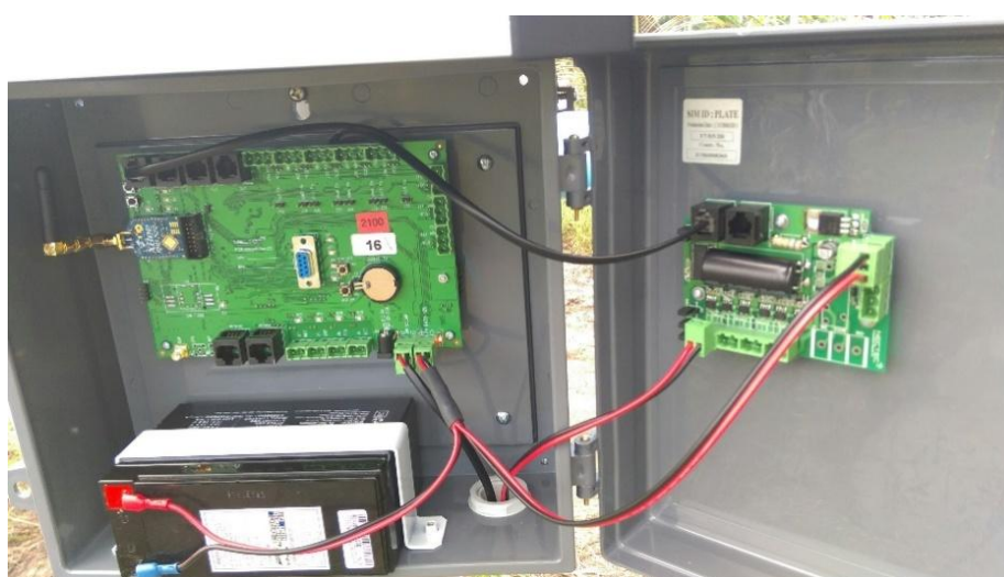
ภาพที่ 28 แสดงบอร์ดควบคุมวาล์วไฟฟ้าในโหนดควบคุมวาล์วรดน้ำ
