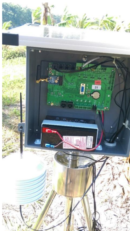
ภาพที่ 24 แสดงบอร์ด MMSIII รุ่นธรรมดา ซึ่งใช้ในโหมดตรวจวัดในแปลงปลูก
