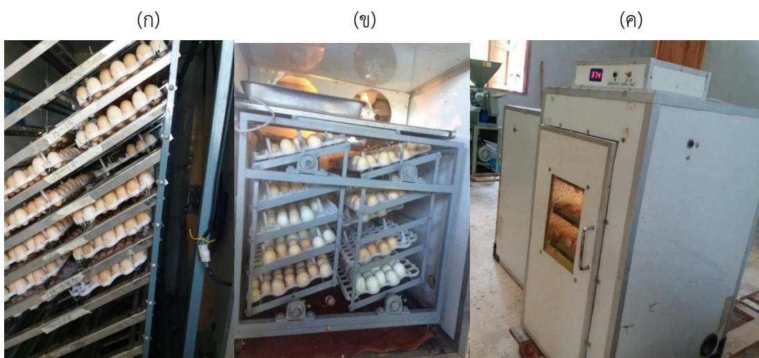
ภาพ 10 ตู้ฟักไข่อัตโนมัติ ขนาด 4,000 ฟอง (ก) 800 ฟอง (ข) และ 200 ฟอง (ค)
