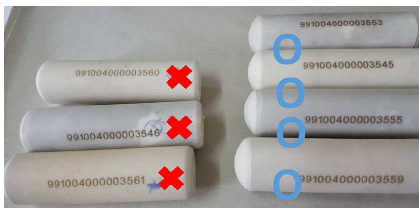
ภาพที่ 3.4 RFID Bolus tag พร้อมพิมพ์รหัสหมายเลข
