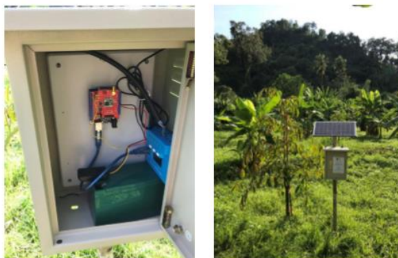
ภาพที่ 4.32 ชุดอุปกรณ์ต้นแบบสำหรับระบบสารสนเทศเพื่อใช้ในการเฝ้าติดตามปัจจัยที่มีผลกระทบต่อการผลิตและภัยธรรมชาติแบบเรียลไทม์ในพื้นที่วนเกษตร จังหวัดอุดรธานี
