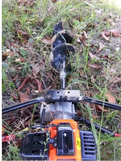
ภาพที่ 40 : เครื่องมือขุดหลุมสำหรับการให้ปุ๋ยแบบฝังกลบ เป็นสิ่งที่ชาวสวนเงาะนอกฤดู
