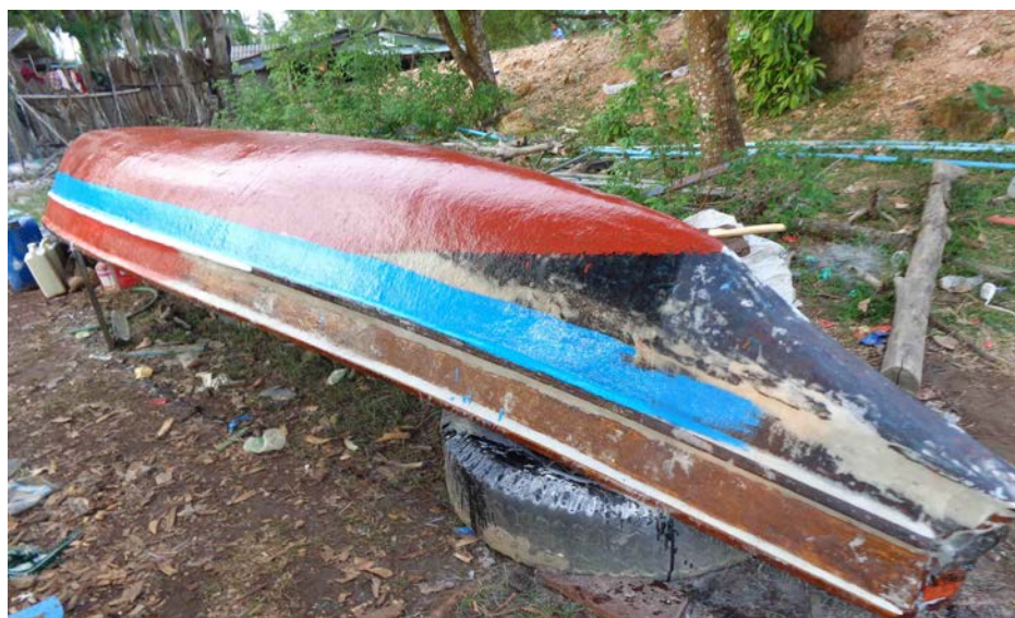
ภาพที่ 5.12 : เรือที่ผ่านการซ่อมแซมด้วยวัสดุไฟเบอร์กลาสแล้ว
