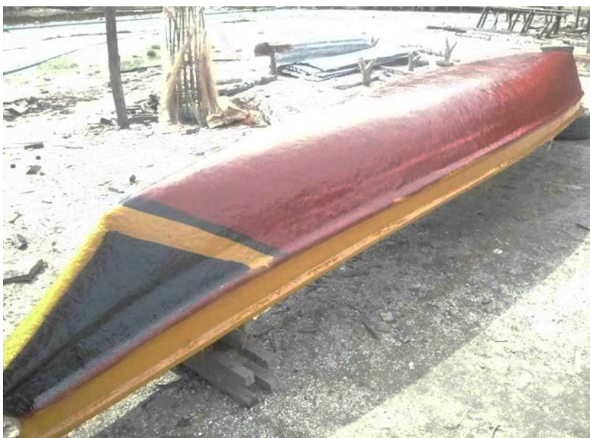
ภาพที่ 4.6 : การซ่อมแซมเรือด้วยนวัตกรรมไฟเบอร์กลาส
