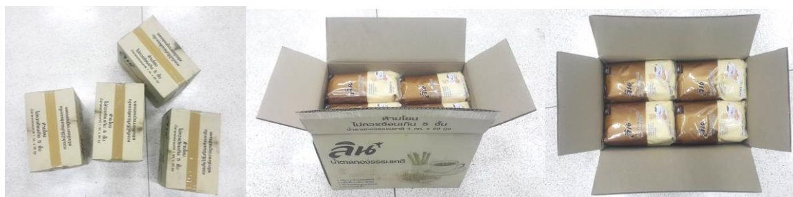
รูปที่ 5.3-6 ลักษณะโดยรวมกล่องบรรจุผลิตภัณฑ์น้ำตาลที่ผ่านการทดสอบการสั่นสะเทือน ที่ระดับความถี่ 1.5, 2.0, 2.5, 3.0, 3.5, 4.0, 4.5 และ 5 Hz เป็นเวลา 1 ชั่วโมง
