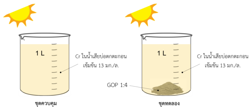
รูปที่ 5.2.5 ไดอะแกรมแสดงการทดลองเพื่อเลียนแบบการใช้วัสดุดูดซับ GOP ในบ่อดักตะกอนของโรงงานฟอกย้อมโดยแบ่งเป็นชุดควบคุม (ซ้าย) และชุดทดลอง (ขวา)
