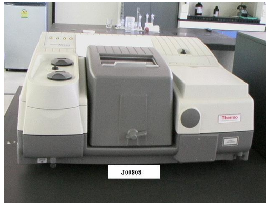
(ค) เครื่องมือวิเคราะห์ ตรวจสอบและศึกษาเกี่ยวกับโมเลกุลของสารและการวิเคราะห์เชิงคุณภาพอินฟราเรด
