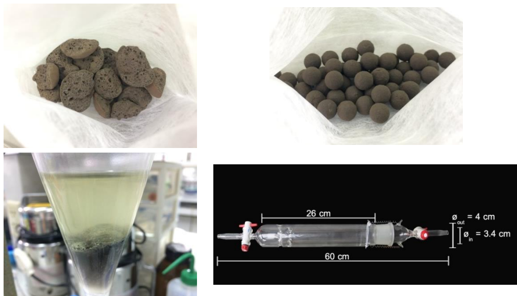
รูปที่ 5.6.1 ภาพแสดงการทดลองขึ้นรูปและวิธีการนำ GOP ไปใช้ในลักษณะต่าง ๆ ซึ่งเป็นหนึ่งในการศึกษาเพื่อหาลักษณะที่เหมาะสมที่สุดในการนำวัสดุดูดซับ GOP ไปใช้งาน
