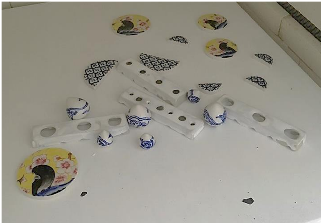
ภาพที่ 5 การเผาชิ้นงานเซรามิกด้วยเตาไฟฟ้า ที่อุณหภูมิ 1,200 องศาเซลเซียส
