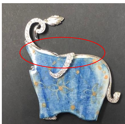
ภาพที่ 3.18 ช่องว่างในการประกอบชิ้นงาน
