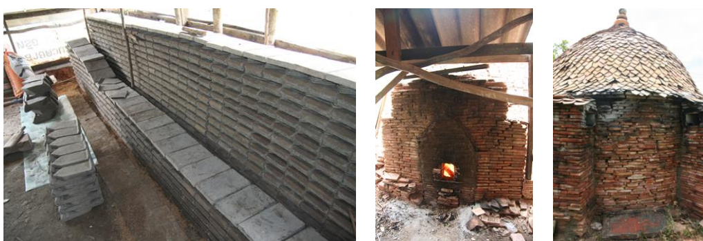
ภาพที่ 1.11 กระเบื้องดิบหลังขึ้นรูปแบบ soft mud process และเตาเผากระเบื้อง ที่บ้านท่านางหอม จังหวัดสงขลา
