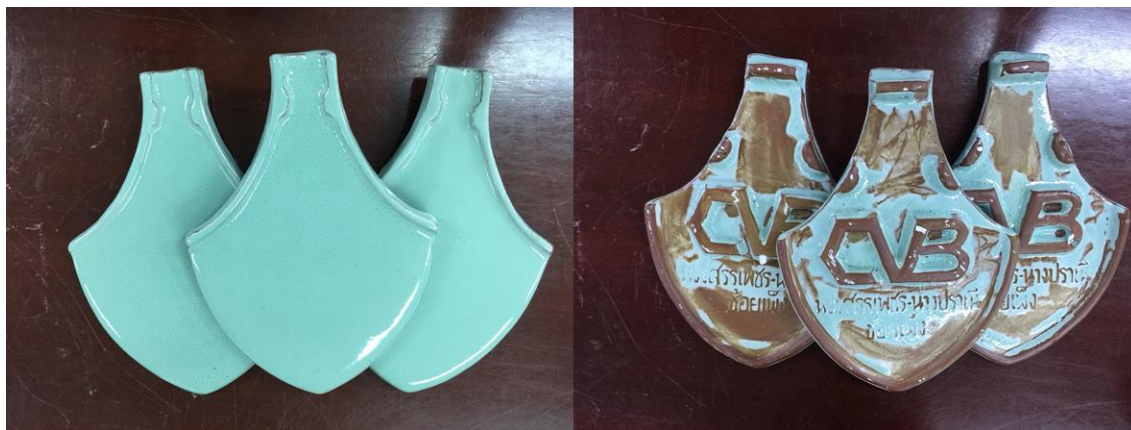
ภาพที่ 2.10 ลักษณะกระเบื้องมุงหลังคาที่ขึ้นรูปด้วยสูตร NLB-1+B หลังเผาที่ 1,150 องศาเซลเซียส หลังเคลือบ
