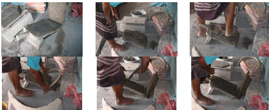
ภาพที่ 1.10 การผลิตกระเบื้องแบบ soft mud process ที่บ้านท่านางหอม จังหวัดสงขลา
