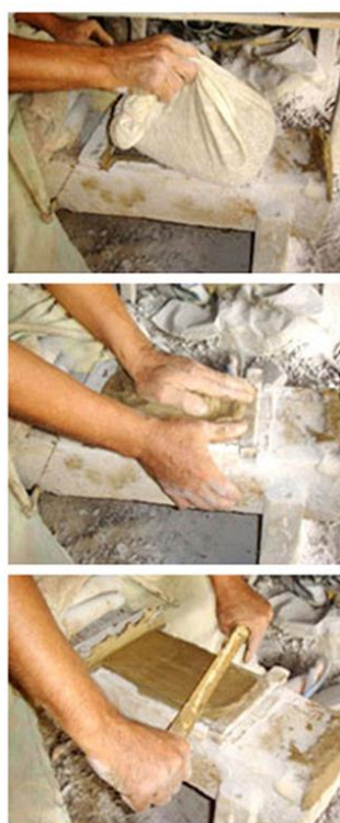
ภาพที่ 1.12 การปั้นกระเบื้องดินเผาบางหลังคาด้วยมือ ที่บ้านป่าตาล จังหวัดเชียงใหม่
