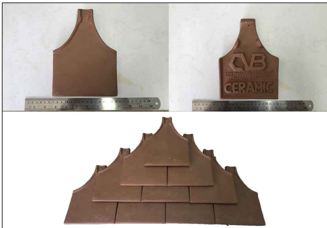
ภาพที่ 2.7 ลักษณะกระเบื้องมุงหลังคาที่ขึ้นรูปด้วยสูตร NLB-1+B หลังเผาที่ 1,150 องศาเซลเซียส
