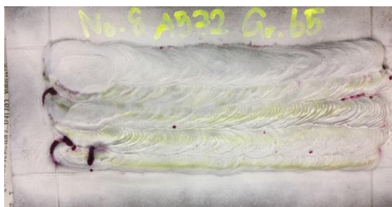
รูปที่ 4.71 ผลการตรวจสอบรอยร้าวด้วยของเหลวแทรกซึมผิวหน้าแนวเชื่อมชิ้นงานเชื่อมทดลอง สภาวะที่ 8
