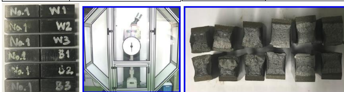
รูปที่ 4.18 ชิ้นทดสอบแรงกระแทกงานเชื่อมพอกแข็ง สภาวะที่ 1
