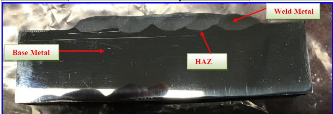
รูปที่ 4.39 แสดงจุดที่ทำการตรวจสอบโครงสร้างจุลภาคขึ้นทดสอบทดลองงานเชื่อม สภาวะที่ 4
