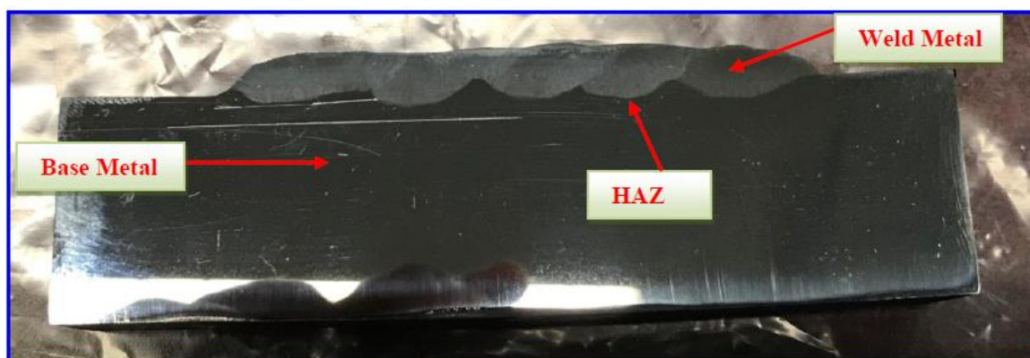
รูปที่ 4.31 แสดงจุดที่ทำการตรวจสอบโครงสร้างจุลภาคขึ้นทดสอบทดลองงานเชื่อม สภาวะที่ 3
