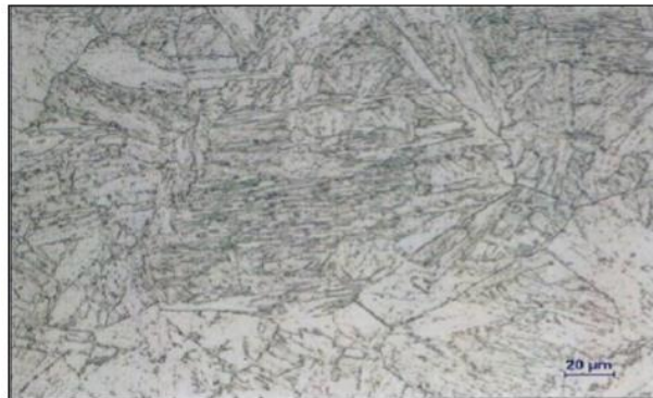
รูปที่ 4.7 โครงสร้างจุลภาคเนื้อโลหะงานบริเวณกระทบร้อน (HAZ) ที่กำลังขยาย 500X
