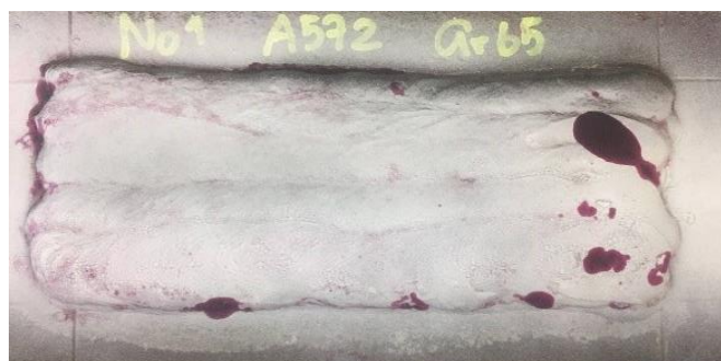
รูปที่ 4.11 ผลการตรวจสอบด้วยสารแทรกซึมแนวเชื่อมสภาวะที่ 1
