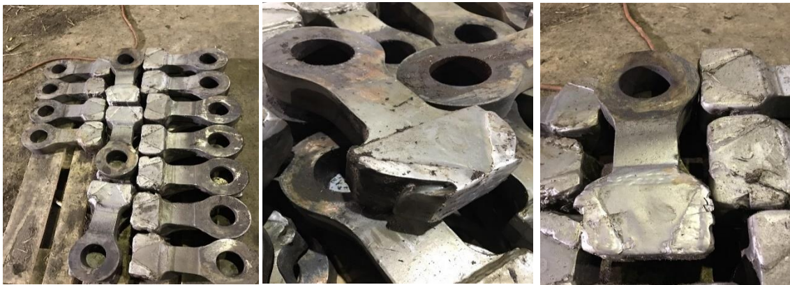
รูปที่ 3.2 สภาพค้อนฉีกอ้อยของโรงงานน้ำตาลบ้านโป่ง จังหวัดราชบุรี
