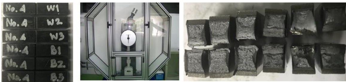
รูปที่ 4.43 ชิ้นทดสอบแรงกระแทกงานเชื่อมพอกแข็ง สภาวะที่ 4
