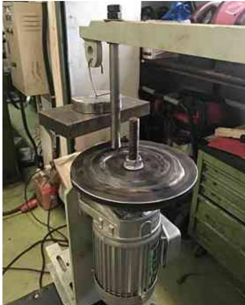
รูปที่ 4.78 เครื่องทดสอบแบบพินออนดิสก์
