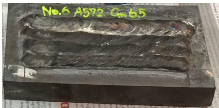
รูปที่ 4.53 ขั้นตอนทดสอบการเชื่อมพอกแข็ง สภาวะที่ 6
