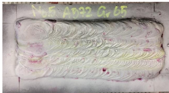
รูปที่ 4.45 ผลการตรวจสอบด้วยสารแทรกซึมแนวเชื่อมสภาวะที่ 5
