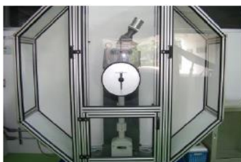
รูปที่ 4.35 ขั้นตอนทดสอบแรงกระแทกงานเชื่อมพอกแข็ง สภาวะที่ 3
