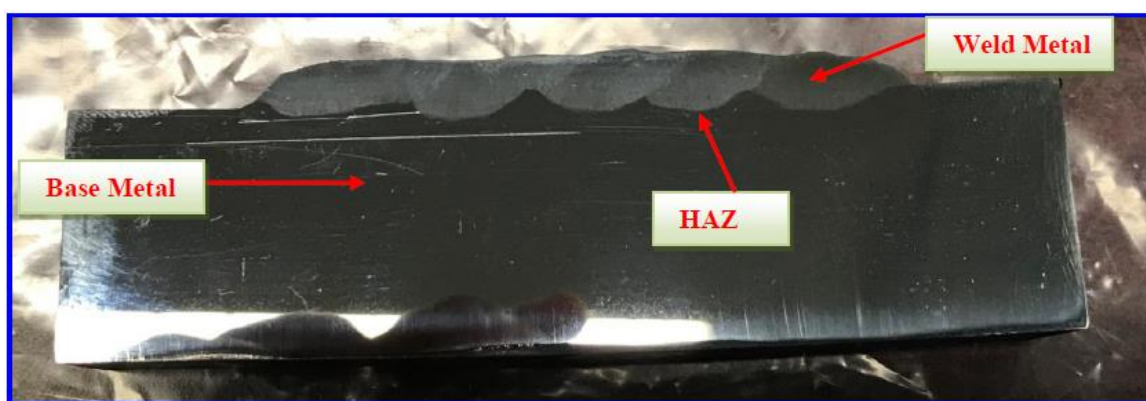
รูปที่ 4.73 แสดงจุดที่ทำการตรวจสอบโครงสร้างจุลภาคขึ้นทดสอบทดลองงานเชื่อม สภาวะที่ 8
