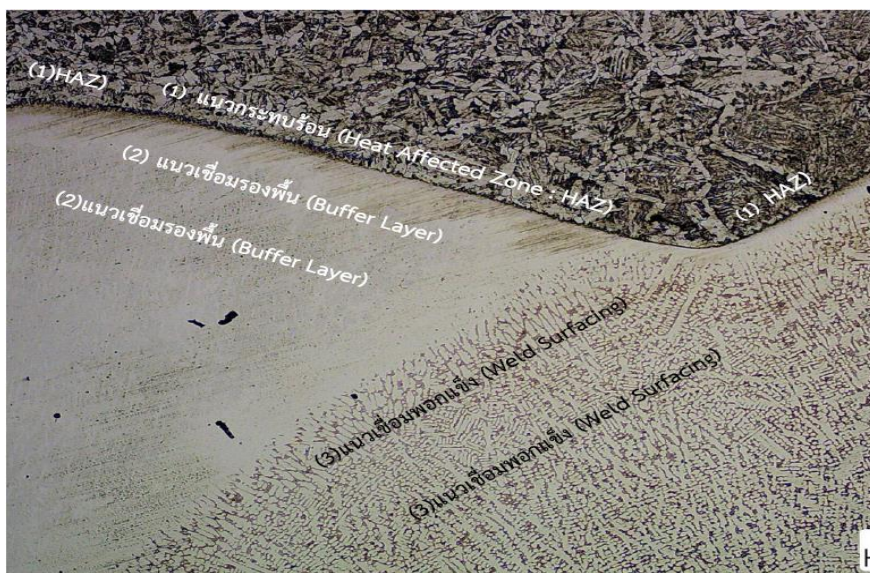
รูปที่ 4.50 ลักษณะภาพถ่ายของโครงสร้างจุลภาคบริเวณกระทบร้อน (HAZ) , แนวเชื่อมรองพื้น (Buffer layer) และแนวเชื่อมพอกแข็ง (Hard surfacing layer) - Magnification 50X
