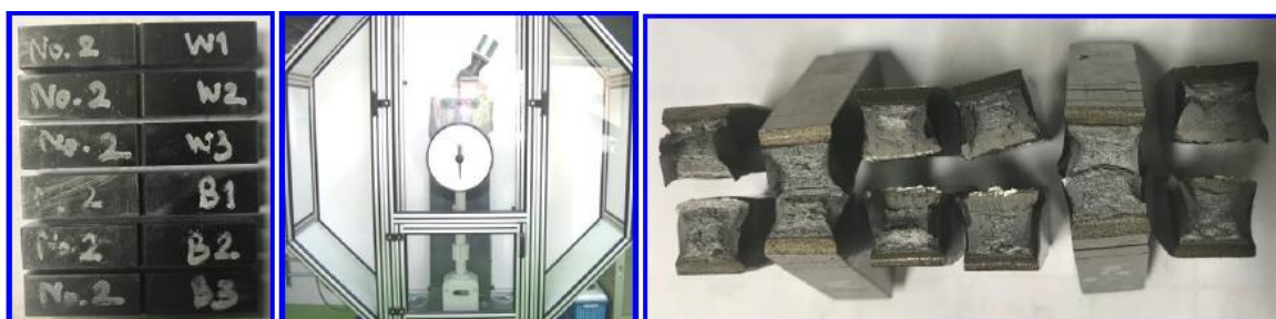
รูปที่ 4.27 ชิ้นทดสอบแรงกระแทกงานเชื่อมพอกแข็ง สภาวะที่ 2
