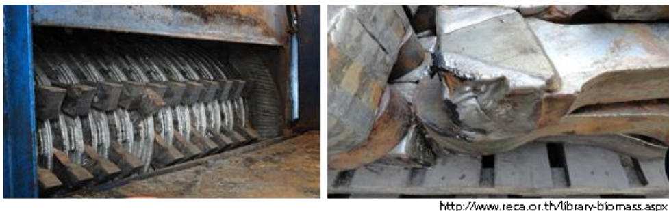
รูปที่ 1.1 ปัญหาการเสื่อมสภาพของชั้นผิวพอกแข็งบนค้อนฉีกอ้อย
