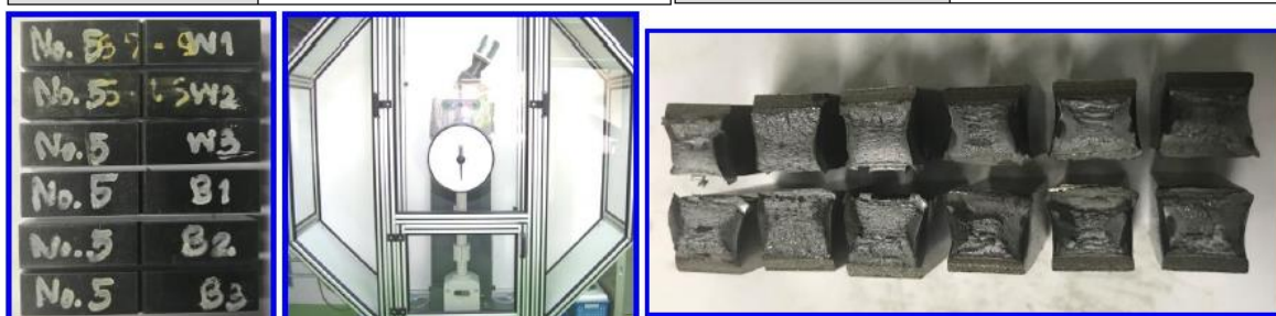
รูปที่ 4.52 ขึ้นทดสอบแรงกระแทกงานเชื่อมพอกแข็ง สภาวะที่ 5
