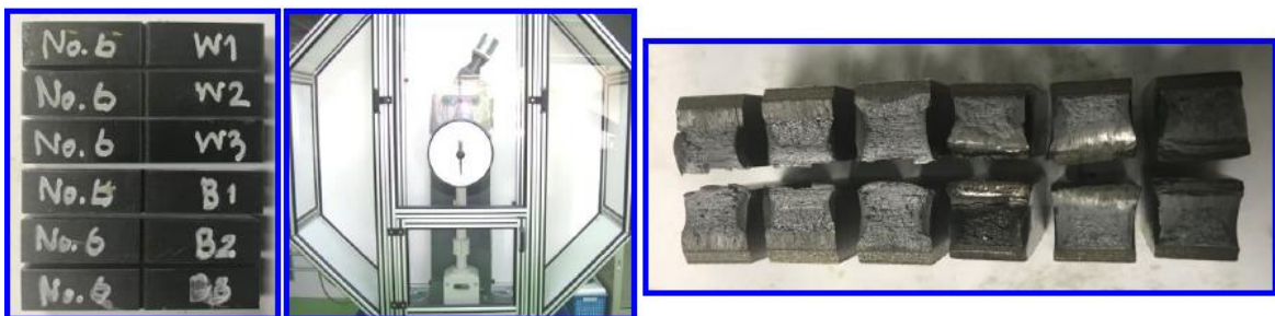
รูปที่ 4.61 ชิ้นทดสอบแรงกระแทกงานเชื่อมพอกแข็ง สภาวะที่ 6
