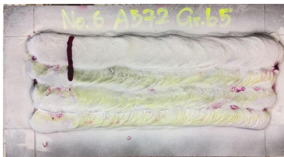
รูปที่ 4.54 ผลการตรวจสอบด้วยสารแทรกซึมแนวเชื่อมสภาวะที่ 6
