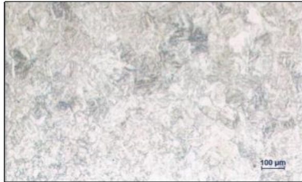
รูปที่ 4.6 โครงสร้างจุลภาคเนื้อโลหะงานบริเวณกระทบร้อน (HAZ) ที่กำลังขยาย 100X
