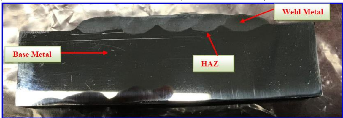
รูปที่ 4.65 แสดงจุดที่ทำการตรวจสอบโครงสร้างจุลภาคชิ้นทดสอบทดลองงานเชื่อม สภาวะที่ 7
