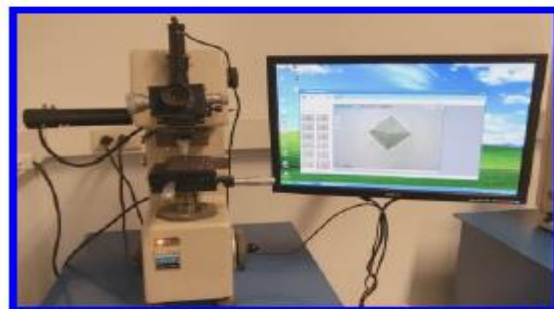
รูปที่ 4.51 การทดสอบความแข็ง Micro Vickers Test ชิ้นงานทดสอบเชื่อมพอกแข็ง สถานะที่ 5
