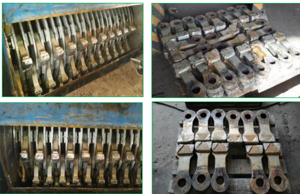
รูปที่ 3.3 สภาพค้อนฉีกอ้อยของโรงงานน้ำตาลมิตรผล สิงห์บุรี
