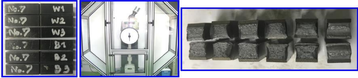
รูปที่ 4.69 ขั้นตอนทดสอบแรงกระแทกงานเชื่อมพอกแข็ง สภาวะที่ 7
