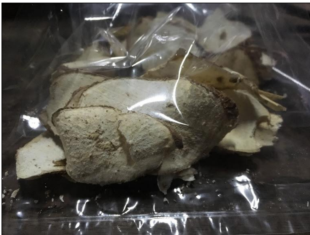
ภาพที่ 38 ภาพแสดงชิ้นไม้ทดสอบนำมาหาค่าความชื้น
