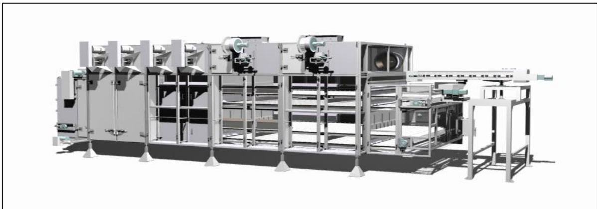
ภาพที่ 9 ตัวอย่างเครื่องอบแห้งแบบสายพานและมีความดันภายในต่ำกว่าบรรยากาศ
