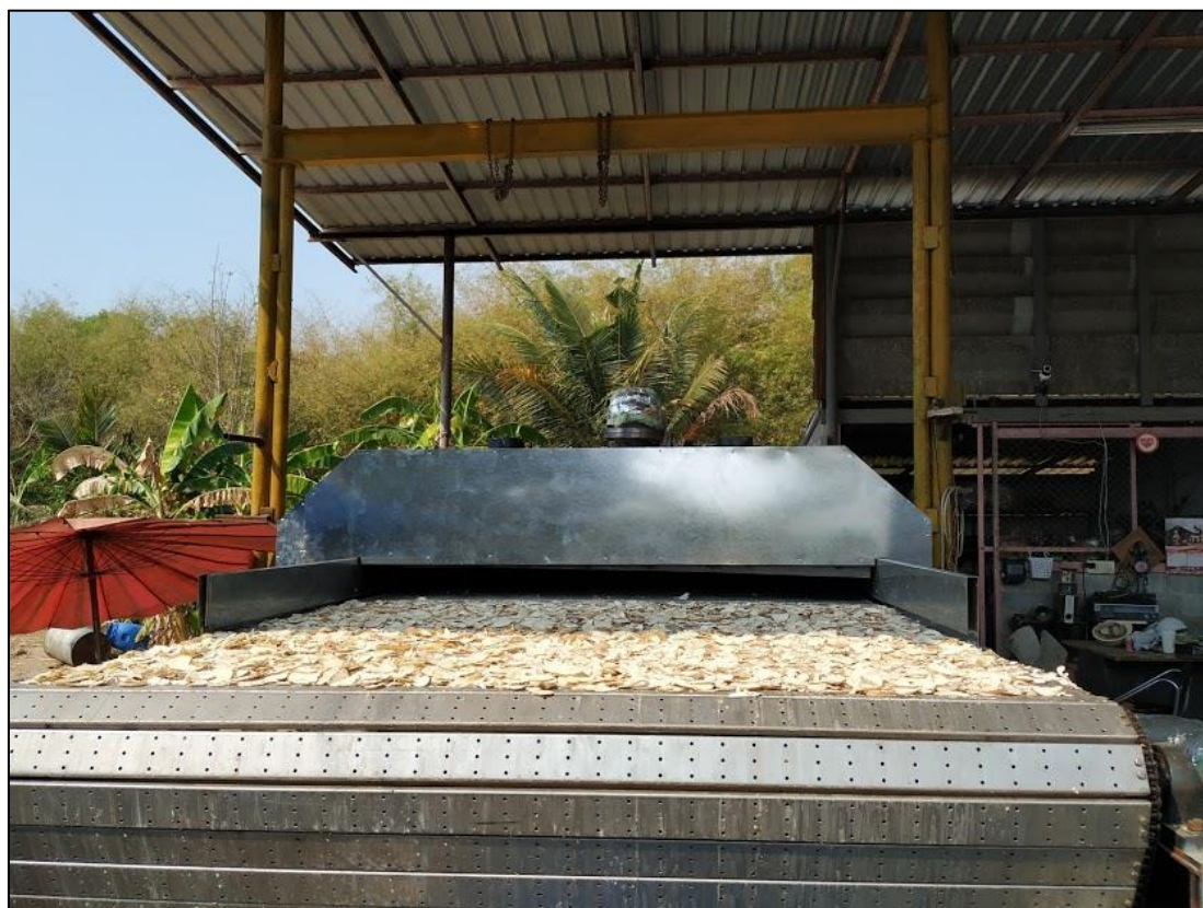
ภาพที่ 36 ภาพแสดงชิ้นมันทดสอบบนสายพานก่อนเข้าสู่ห้องอบ
