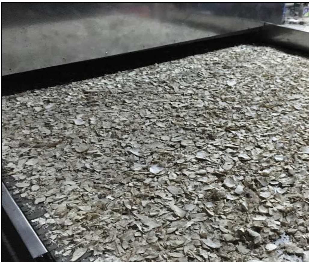
ภาพที่ 37 ภาพแสดงชิ้นไม้หลังเข้ากระบวนการอบ
