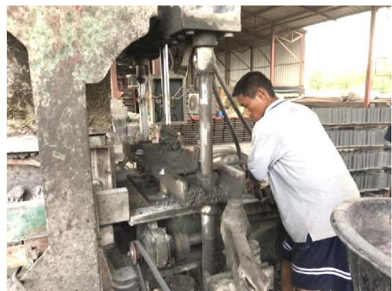
เปิดเครื่องสำหรับอัดส่วนผสมคอนกรีตบล็อก
