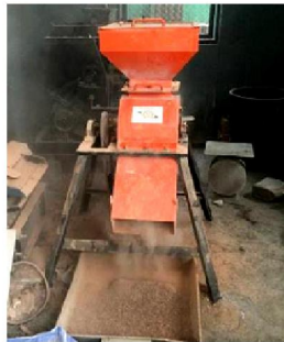
รูปที่ 6 บดย่อยเซรามิกด้วยเครื่องบดย่อยที่ติดตั้งตะแกรงเบอร์ 4
