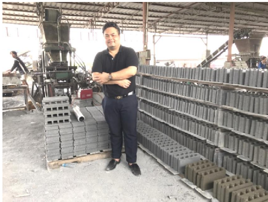
บ่มก้อนตัวอย่างคอนกรีตบล็อกในสภาพบรรยากาศ
