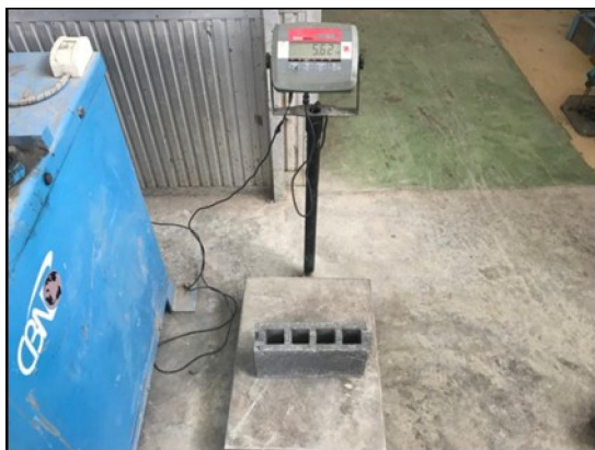
ชั่งน้ำหนักก้อนตัวอย่างคอนกรีตบล็อก
