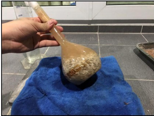
ไล่ฟองอากาศการเพื่อหาความถ่วงจำเพาะ
