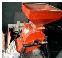
รูปที่ 2 เครื่องบดย่อยเซรามิกติดตั้งตะแกรงเบอร์ 4
