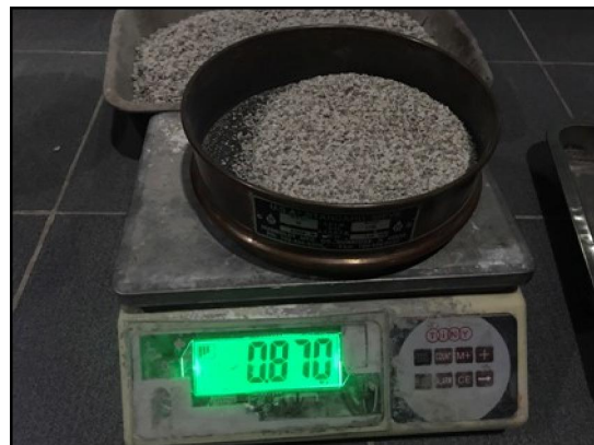
ชั่งน้ำหนักที่ค้ำบนตะแกรงหาโมดูลัสความละเอียด
