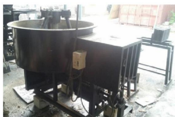
รูปที่ 3 เครื่องผสมคอนกรีต
