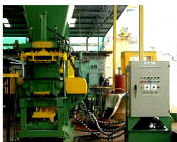
รูปที่ 4 เครื่องอัดขึ้นรูปคอนกรีตบล็อก
