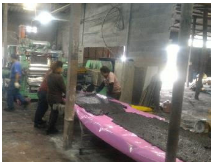
รูปที่ 4.21 การจัดเรียงยางที่รีดบนตะแกรงหลังผ่านการรีด
