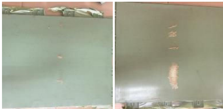
รูปที่ 2 แผ่นยางปูพื้นที่มีตำหนิ เกิดจากยางคอมพาวด์ที่เปื้อนคราบน้ำมันหล่อลื่นในระหว่างกระบวนการเตรียมยางคอมพาวด์
