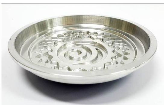
ภาพที่ 4.117 ต้นแบบแม่พิมพ์อลูมิเนียมสำหรับขนมวุ้น ครั้งที่ 2
