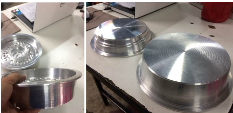
ภาพที่ 4.115 ต้นแบบแม่พิมพ์อลูมิเนียมสำหรับขนมวุ้น ครั้งที่ 1
