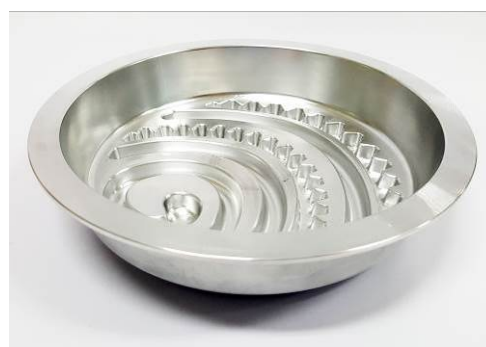
ภาพที่ 4.117 ต้นแบบแม่พิมพ์อลูมิเนียมสำหรับขนมวุ้น ครั้งที่ 2
