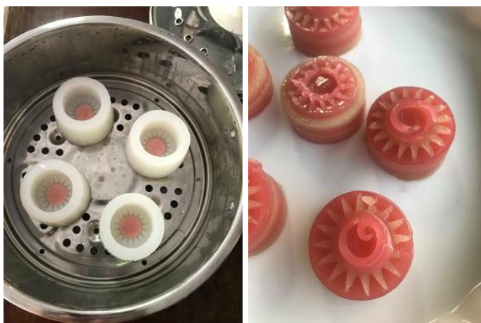
ภาพที่ 4.121 ต้มแบบแม่พิมพ์ขนมชั้น และทำการทดสอบครั้งที่ 1
