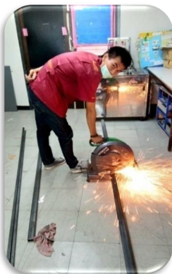
ภาพที่ 3.5 แสดงการตัดเหล็กเพื่อนำมาขึ้นโครงสร้าง ภาพที่ 3.6 แสดงการเชื่อมโครงสร้างเครื่องตัดกล้วยกวน
