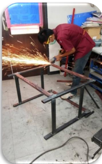
ภาพที่ 3.7 แสดงการเจียรเหล็กโครงสร้างเครื่องตัดกล้วยกวน ภาพที่ 3.8 โครงสร้างเครื่องตัดกล้วยกวน
