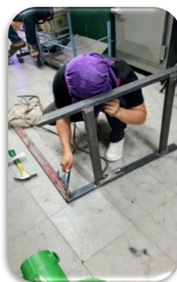
ภาพที่ 3.5 แสดงการตัดเหล็กเพื่อนำมาขึ้นโครงสร้าง ภาพที่ 3.6 แสดงการเชื่อมโครงสร้างเครื่องตัดกล้วยกวน
