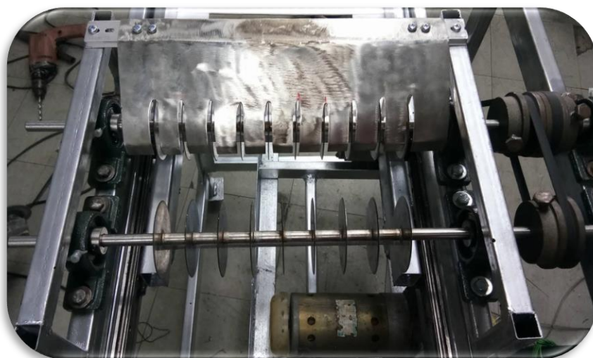
ภาพที่ 3.21 แสดงการติดตั้งชุดบังใบมีด 2 ชุด
