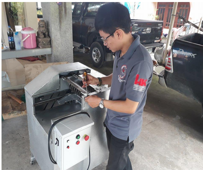
ภาพที่ ข3 ติดตั้งชุดบังใบมีดป้องกันอันตราย
