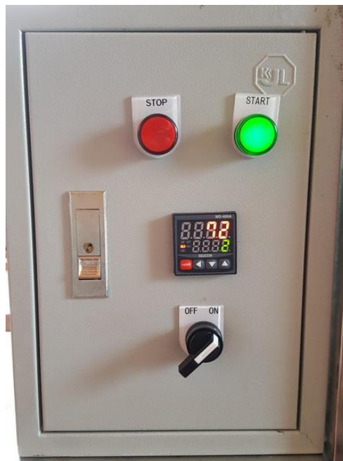
ภาพที่ 3.6 สวิตช์ปิด OFF และ ON เพื่อเปิด-ปิดการทำงานของเครื่อง
