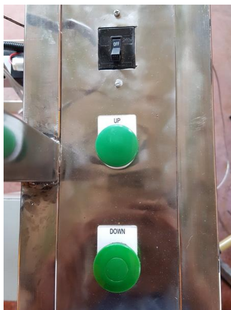
ภาพที่ 3.7 สวิตช์ DOWN และ UP เพื่อบังคับกระบอกสูบทำงาน
