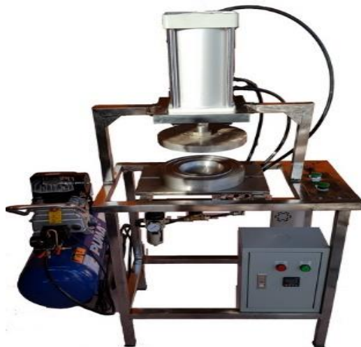
ภาพที่ 5.1 เครื่องอัดขึ้นรูปบรรจุภัณฑ์กาบหมาก
