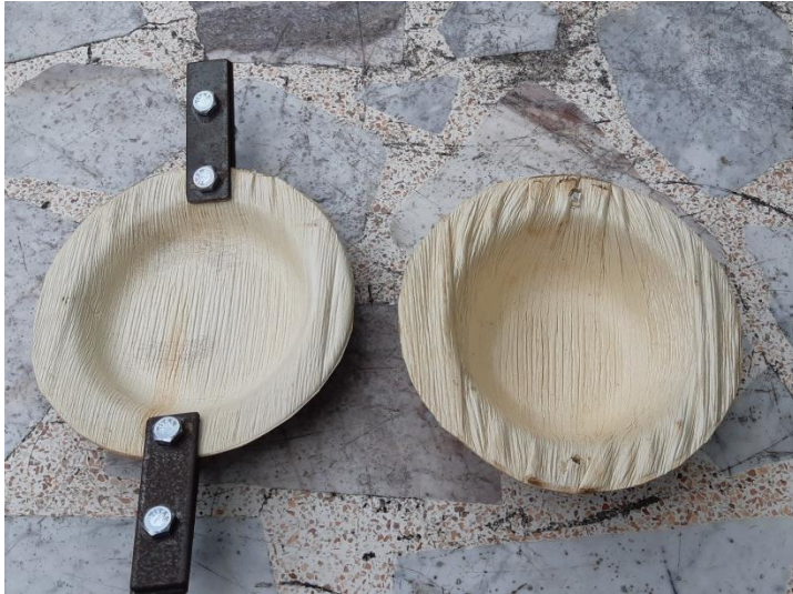
ภาพที่ 4.13 การทดสอบต้านทานต่อแรงดึง และความต้านทานการฉีกขาดของบรรจุภัณฑ์อาหารจากกาบหมากกรมโยธาธิการและผังเมือง หน่วยทดสอบวัสดุ จังหวัดนราธิวาส
