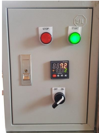
ภาพที่ 4.6 สวิตช์ปิด OFF และ ON เพื่อเปิด-ปิดการทำงานของเครื่อง
