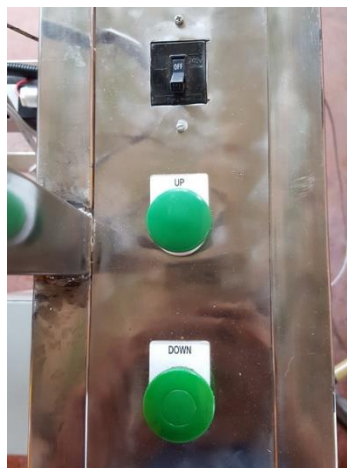
ภาพที่ 4.7 สวิตช์ DOWN และ UP เพื่อบังคับกระบอกสูบทำงาน
