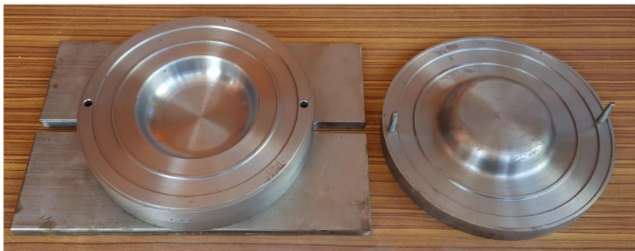
ภาพที่ 4.9 ลักษณะแม่พิมพ์บรรจุภัณฑ์กาบหมาก
