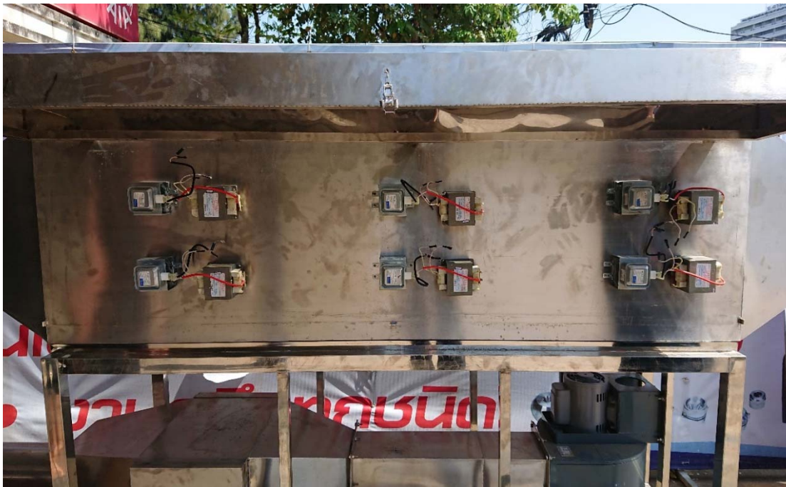
ภาพที่ 7 แมกนีตรอน พร้อมหม้อแปลงห้องอบละ 2 ชุด (ทั้งหมด 6 ชุด ชุดละ 1200 W)
