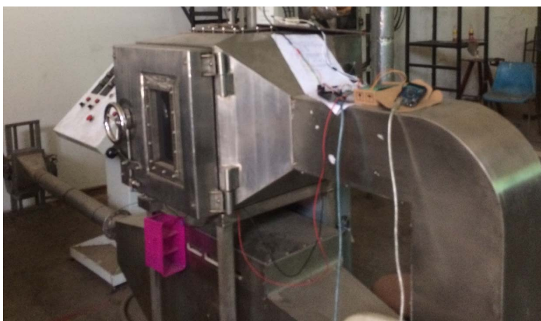
ภาพที่ 1 เครื่องอบแห้งไมโครเวฟร่วมกับลมร้อนที่ใช้ในการศึกษาสภาวะเบื้องต้นของการอบแห้ง
