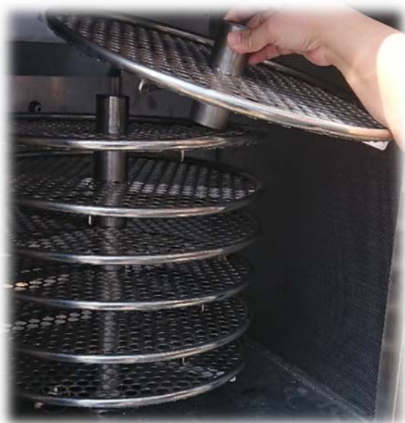
ภาพที่ 4.2 ชั้นวางสับปะรดสดสามารถถอดประกอบได้เพื่อความสะดวกในการใช้งาน
