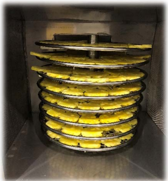
ภาพที่ 4.2 ชั้นวางสับปะรดสดสามารถถอดประกอบได้เพื่อความสะดวกในการใช้งาน
