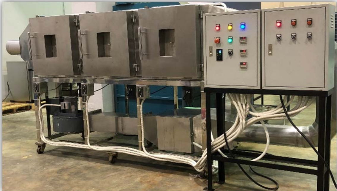
ภาพที่ 4.1 เครื่องอบแห้งสับปะรดพันธุ์ภูเก็ตด้วยไมโครเวฟร่วมกับลมร้อน
