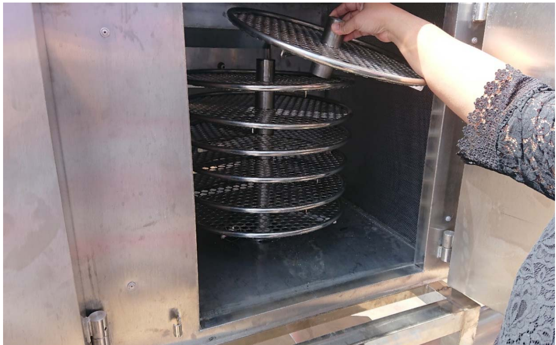
ภาพที่ 6 ถาดสำหรับใส่สับปะรดสดสามารถถอดประกอบได้เพื่อความสะดวกในการทำงาน
