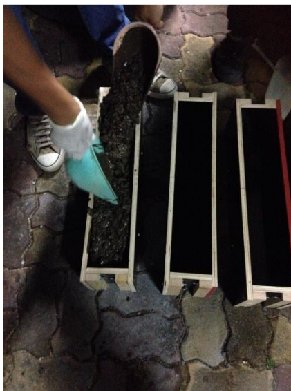
รูปที่ 3.7 แสดงการนำจีโอโพลิเมอร์คอนกรีตใส่แบบเพื่อทดสอบกำลังรับแรงดัด
