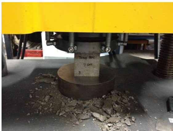
รูปที่ 3.9 แสดงการทดสอบกำลังรับแรงอัดด้วยเครื่อง UTM.
