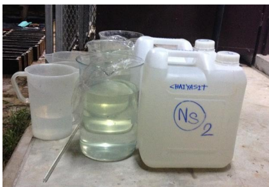
รูปที่ 3.2 แสดงการเตรียมสารละลายโซเดียมไฮดรอกไซด์ ( \text{NaOH} ) และสารโซเดียมซิลิเกต ( \text{Na}_2\text{SiO}_3 ) (ซึ่งน้ำหนักตามอัตราส่วนผสม)
