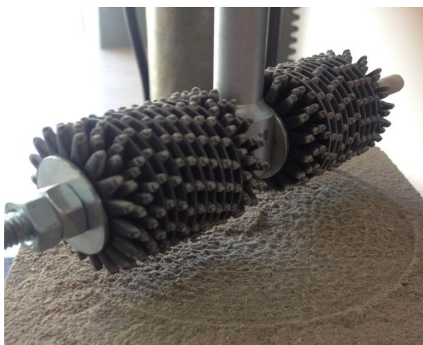
รูปที่ 3.11 แสดงการทดสอบความทนทานต่อการขัดสี
