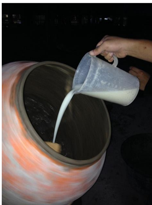
รูปที่ 3.6 แสดงการเติมสารโซเดียมซิลิเกตที่ผสมกับน้ำยางพารา (ผสมเป็นเวลา 3 นาที จนเป็นเนื้อเดียวกัน)
