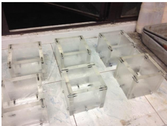
รูปที่ 3.8 แสดงการนำจีโอโพลิเมอร์คอนกรีตใส่แบบเพื่อทดสอบกำลังรับแรงอัดและการขีดสี
