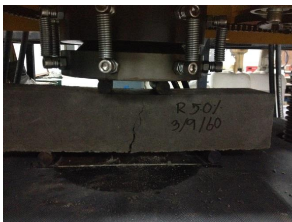
รูปที่ 3.10 แสดงการทดสอบกำลังรับแรงดัดด้วยเครื่อง UTM.
