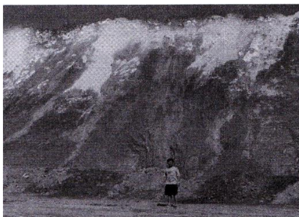
รูปที่ 2.6 กองเถ้าลอยจากระบบเตาเผาแบบใช้ถ่านหินบด โรงไฟฟ้าแม่เมาะ
