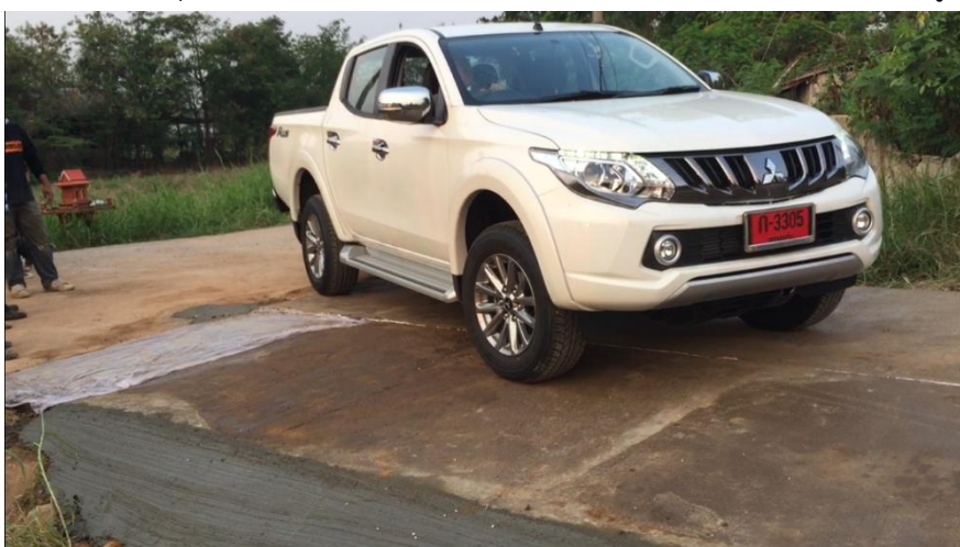
รูปที่ 4.35 ทดสอบผิวถนนจีโอโพลิเมอร์คอนกรีตผสมน้ำยางพาราหลังการเทช่องสุดท้ายเสร็จเป็นระยะเวลา 30 นาที
