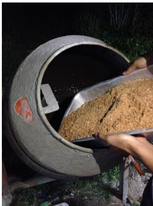
รูปที่ 3.4 แสดงการผสมมวลรวมละเอียด (ผสมเป็นเวลา 3 นาที จนเป็นเนื้อเดียวกัน)
